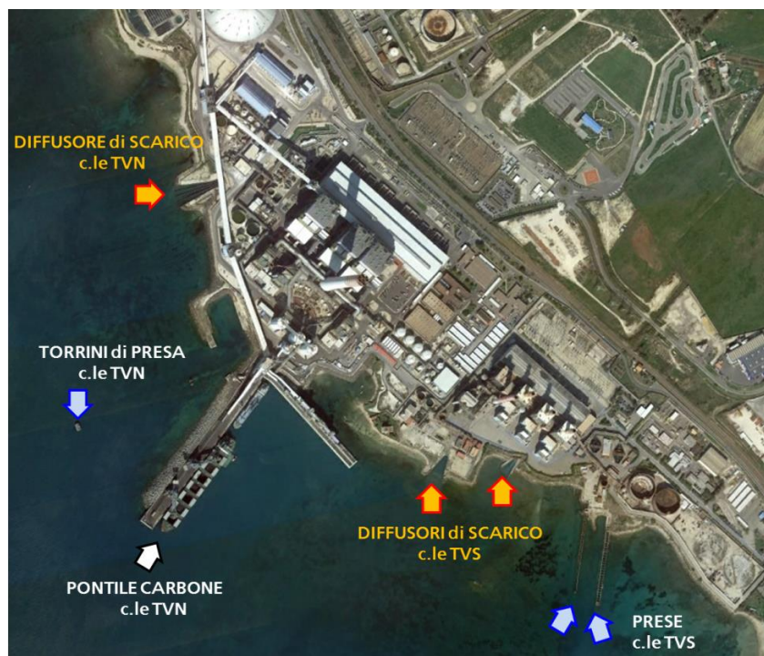
Figura 2 Localizzazione delle opere di presa e di scarico degli impianti di Torrevaldaliga Nord (Enel Produzione) e Sud (Tirreno Power) (foto satellitare da Rif. 4)
