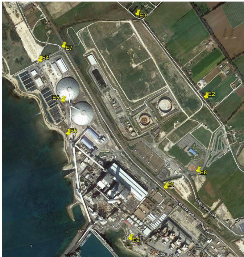
Figura 4 – C.le di Torvaldaliga: ubicazione dei punti di misura del rumore ambientale E1-E9
