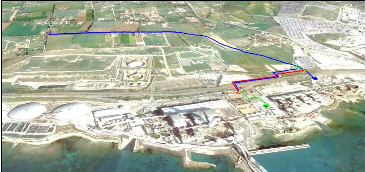
Foto 2.1 – Immagine 3D dell'area in cui si snoda il tracciato del metanodotto (linea rossa, in blu met. esistenti, in verde met. da porre fuori esercizio))
