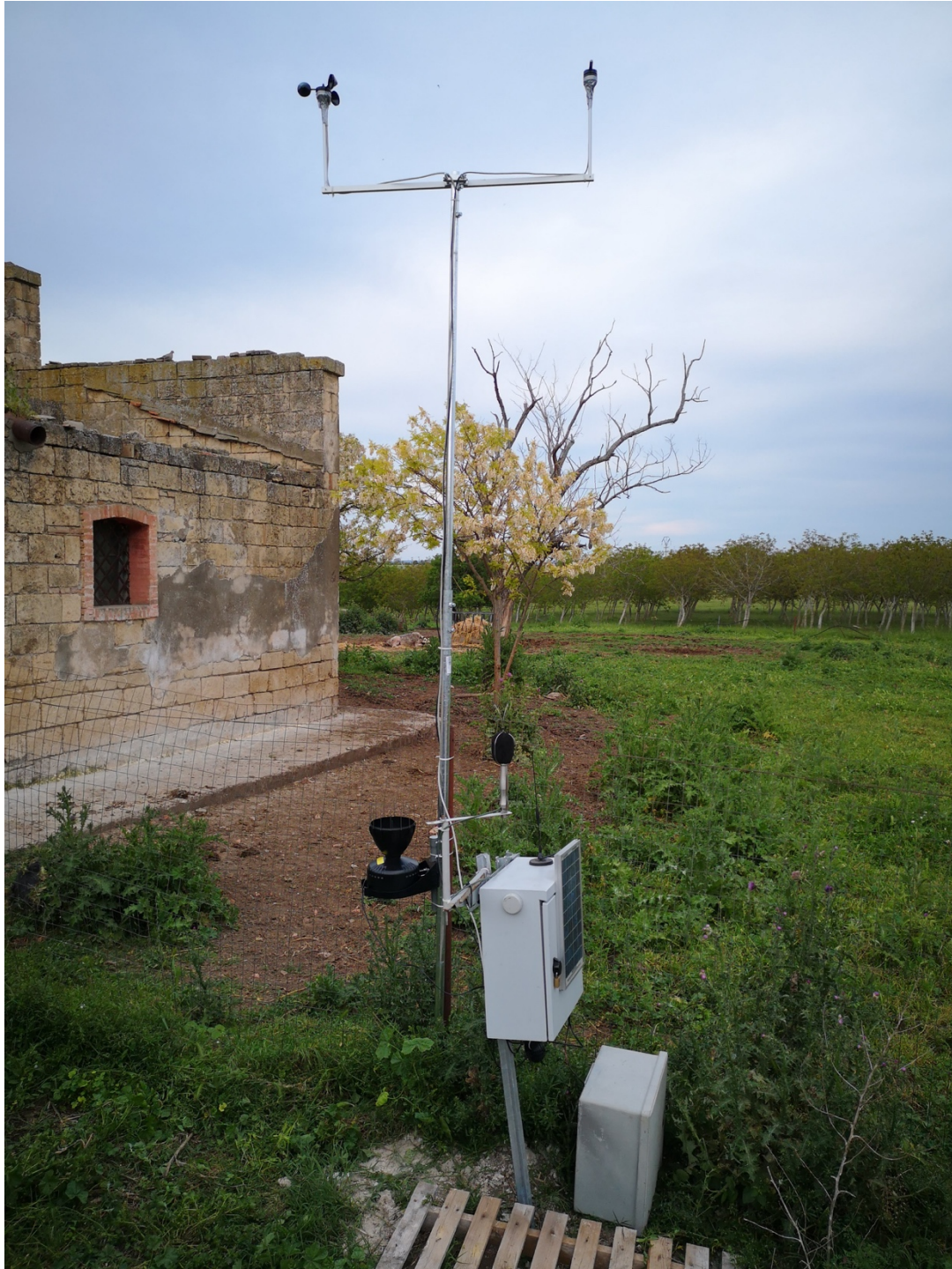
Figura 20 – Ricettore R15 – SR 61530 – posizione della stazione di misura, vento, pioggia, temperatura e rumore
