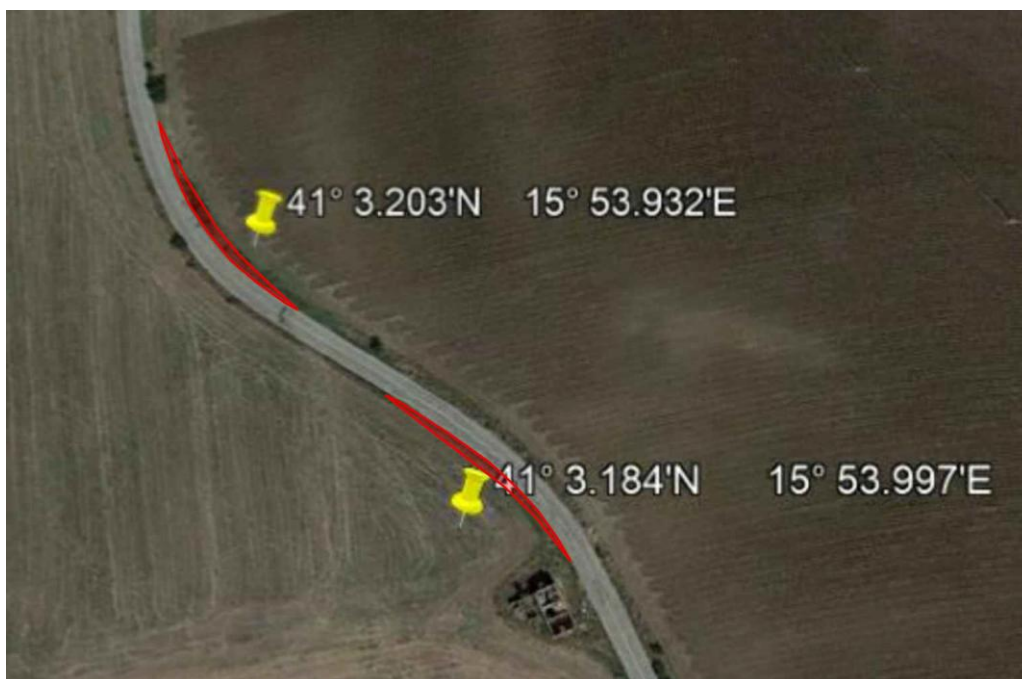
Figura 9 – Allargamenti in curva della carreggiata stradale
