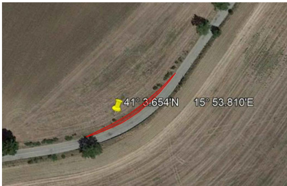
Figura 13 – Allargamenti in curva della carreggiata stradale
