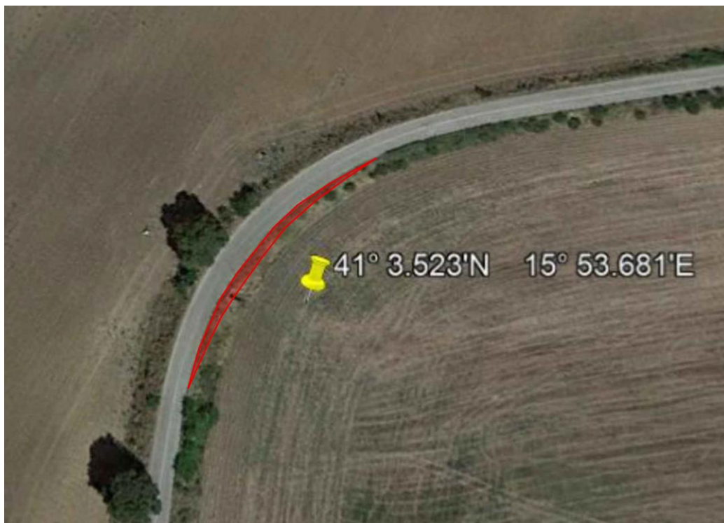
Figura 11 – Allargamenti in curva della carreggiata stradale
