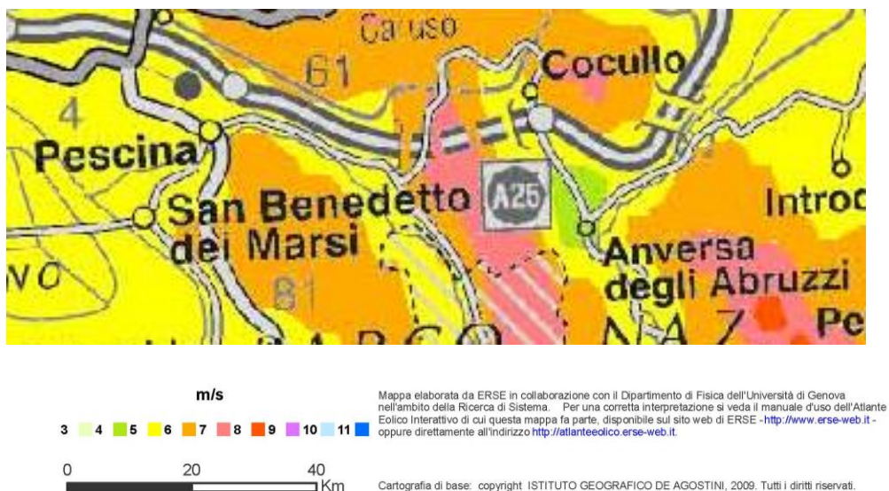
Scala 1:750.000 Mappa della velocità media annua del vento a 100 m s.l.t./s.l.m. Tavola 17
