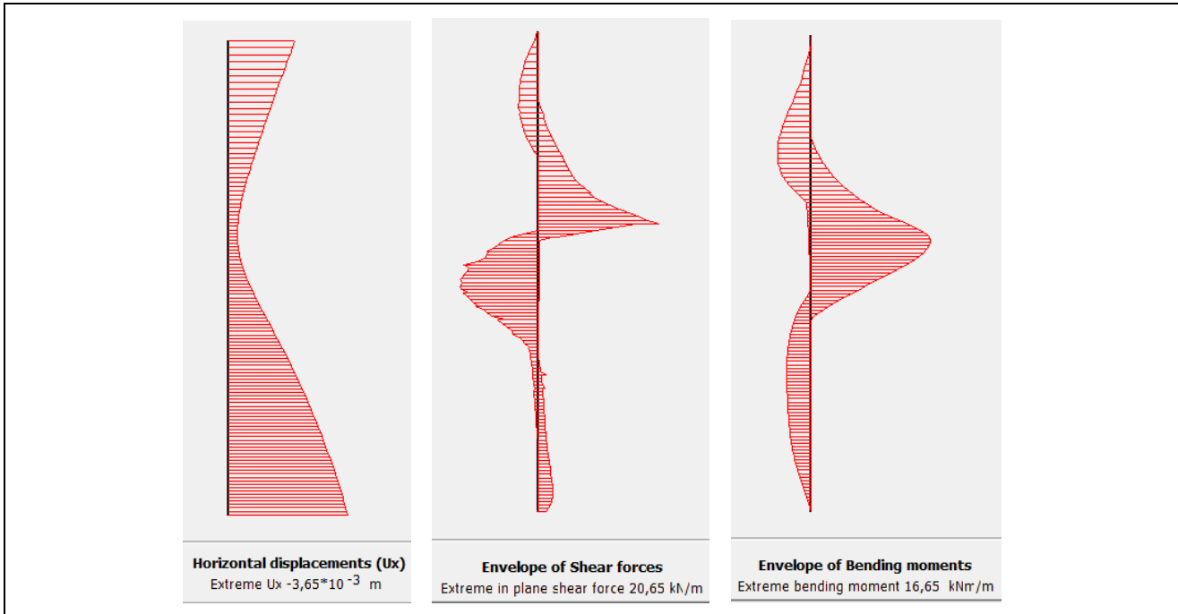
Figura 3.3.3 – Spostamenti, taglio e momento flettente SLU-STR
