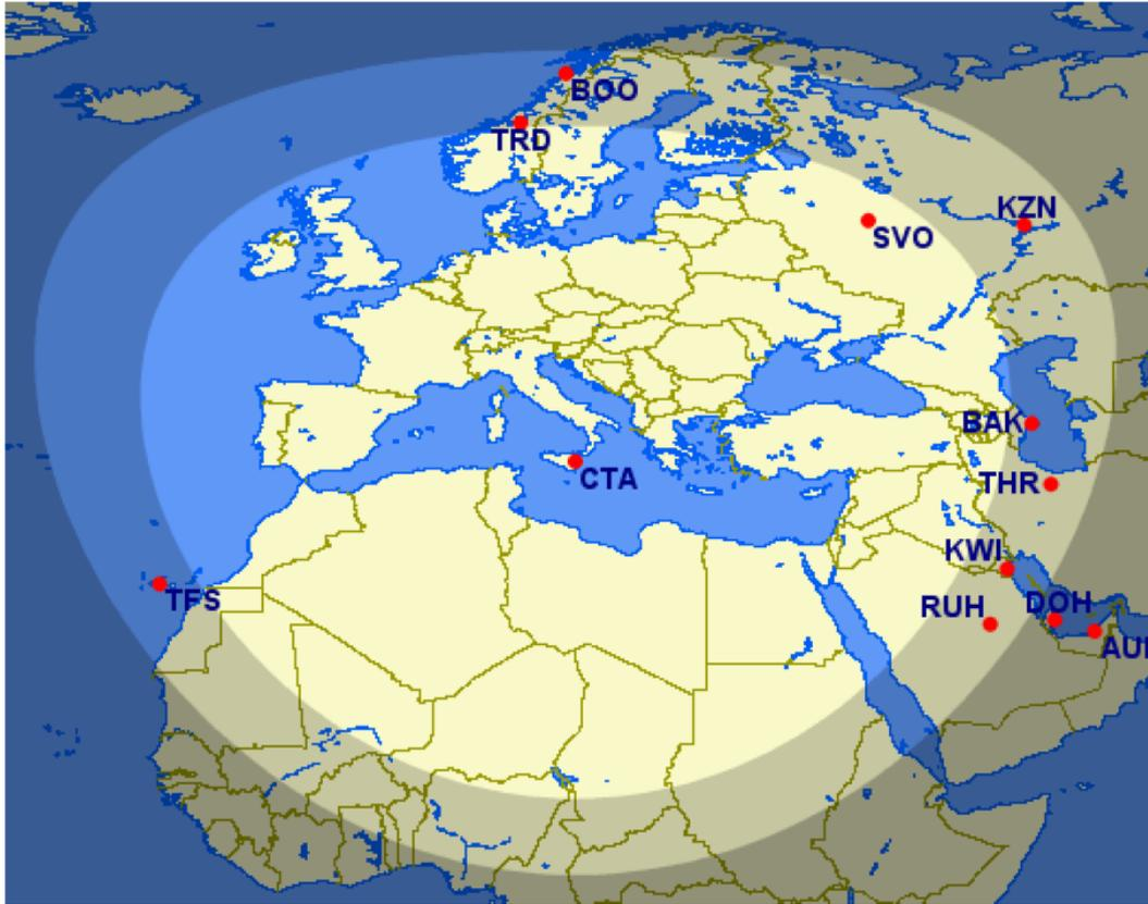
Figura 9 – Limitazione teorica per un B737-800 qualora la situazione attuale dovesse essere adattata e conforme alle norme EASA relativamente alle RESA
