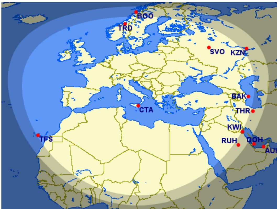
Figura 25 - Limitazione teorica per un B737-800 qualora la pista dovesse essere realizzata nuova parallela e conforme alle norme EASA relativamente alle RESA. Si confronti con la precedente Figura 9
