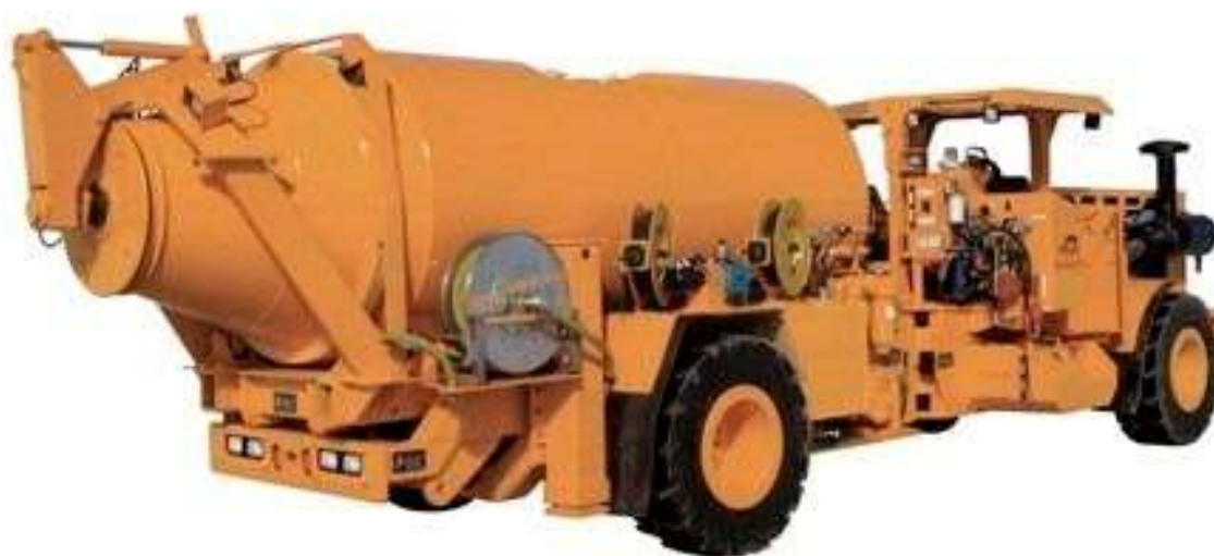
Figura 6-1: Mezzo per trasporto e caricamento dell'esplosivo sfuso in sotterraneo
