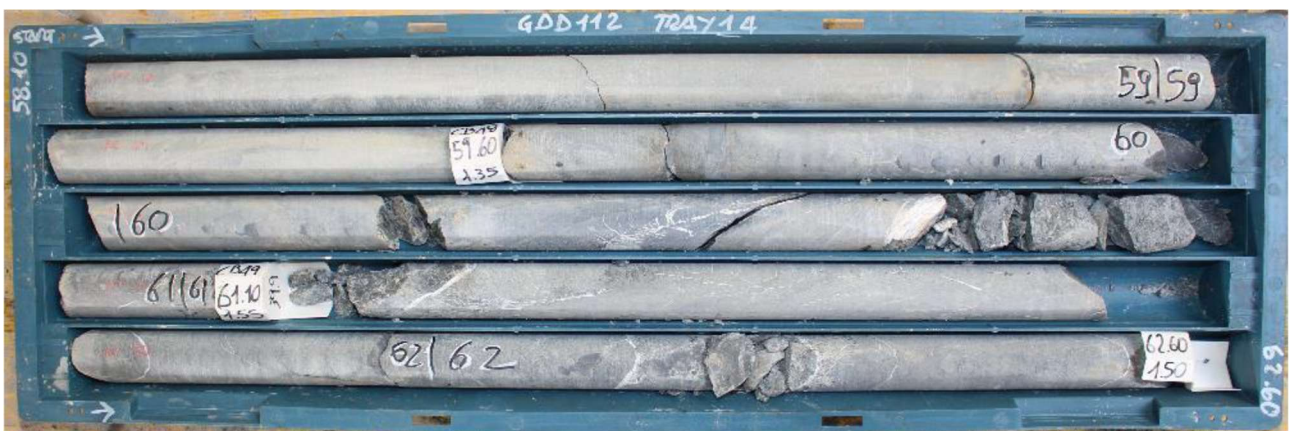
Figura 8-16: Esempio di arenaria (SA).
