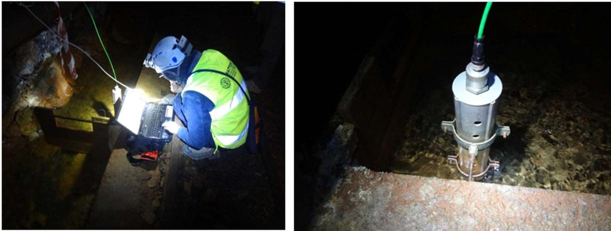
FIGURA 4-23-controllo dei dati in corrispondenza DELLA PK 1900 con dispositivo di misurazione del livello
