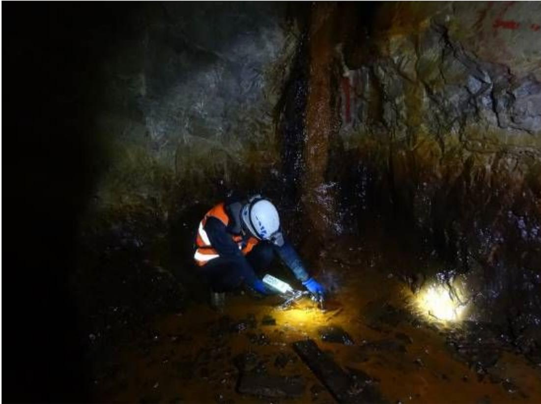
*Figura 216 - Misura dei parametri fisici delle risorgive all'interno della galleria Riso Parina (Pk 11+000).*
