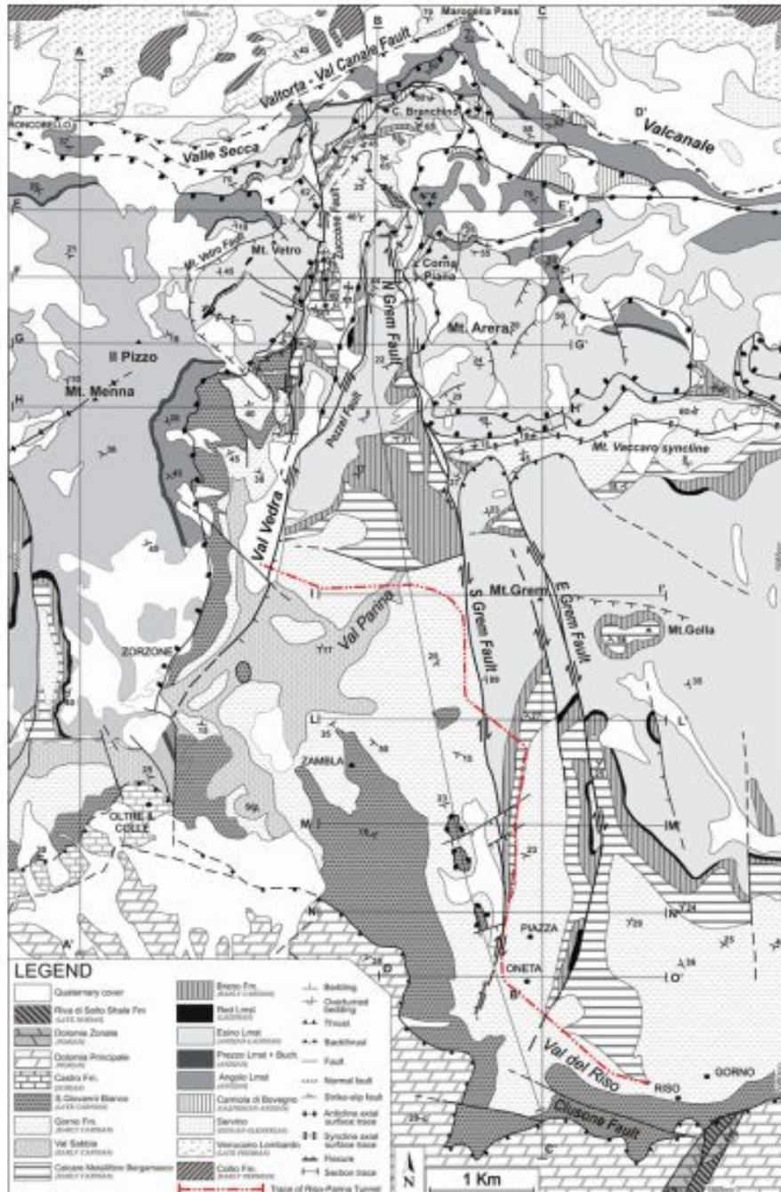
Figura 244 - Schema geologico – strutturale traversale dell’area Grem-Vedra che include l’area di progetto (Zanchi et Al., 2012).
