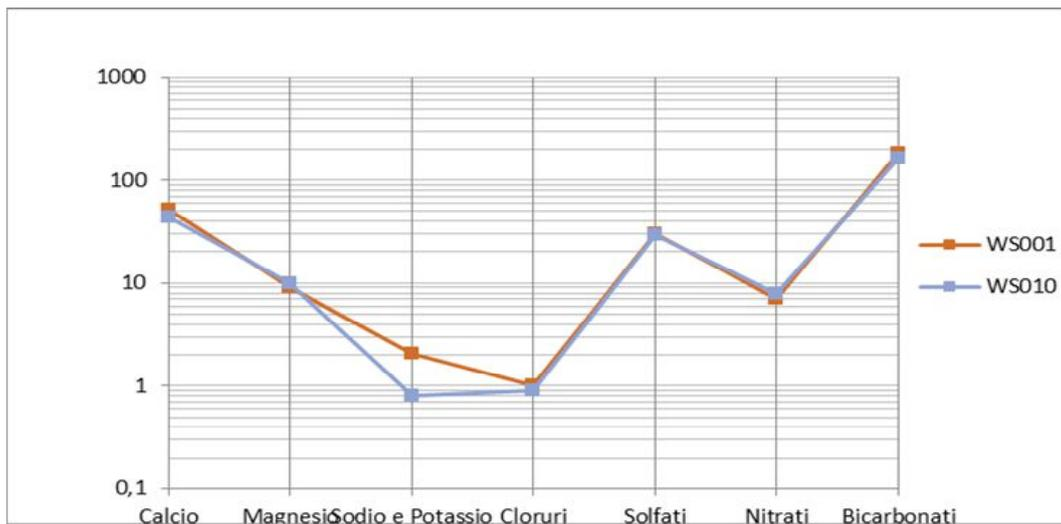
Figura 226 - Diagramma di Shoeller relativo ai campioni WS001-WS0010.
