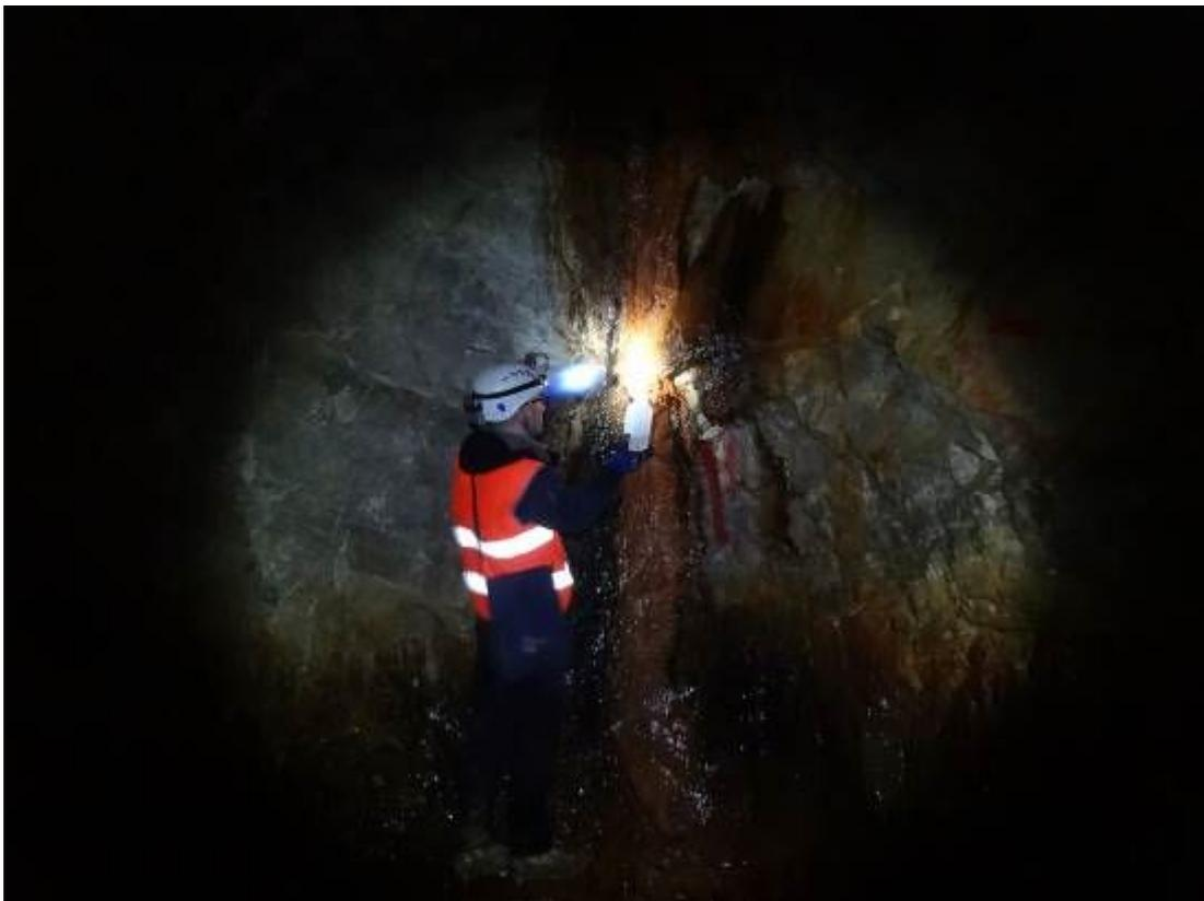
*Figura 217 - Campionamento delle acque all'interno della galleria Riso Parina (Pk 11+000) su cui eseguire le analisi geochimiche in laboratorio.*
