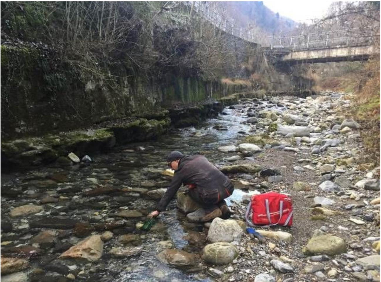
*Figura 218 - Campionamento delle acque del torrente Riso a valle della Laveria esistente.*
