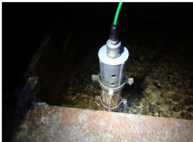
Figura 238 - Controllo dei dati in corrispondenza della PK 1900 e dettaglio del dispositivo di misurazione del livello.
