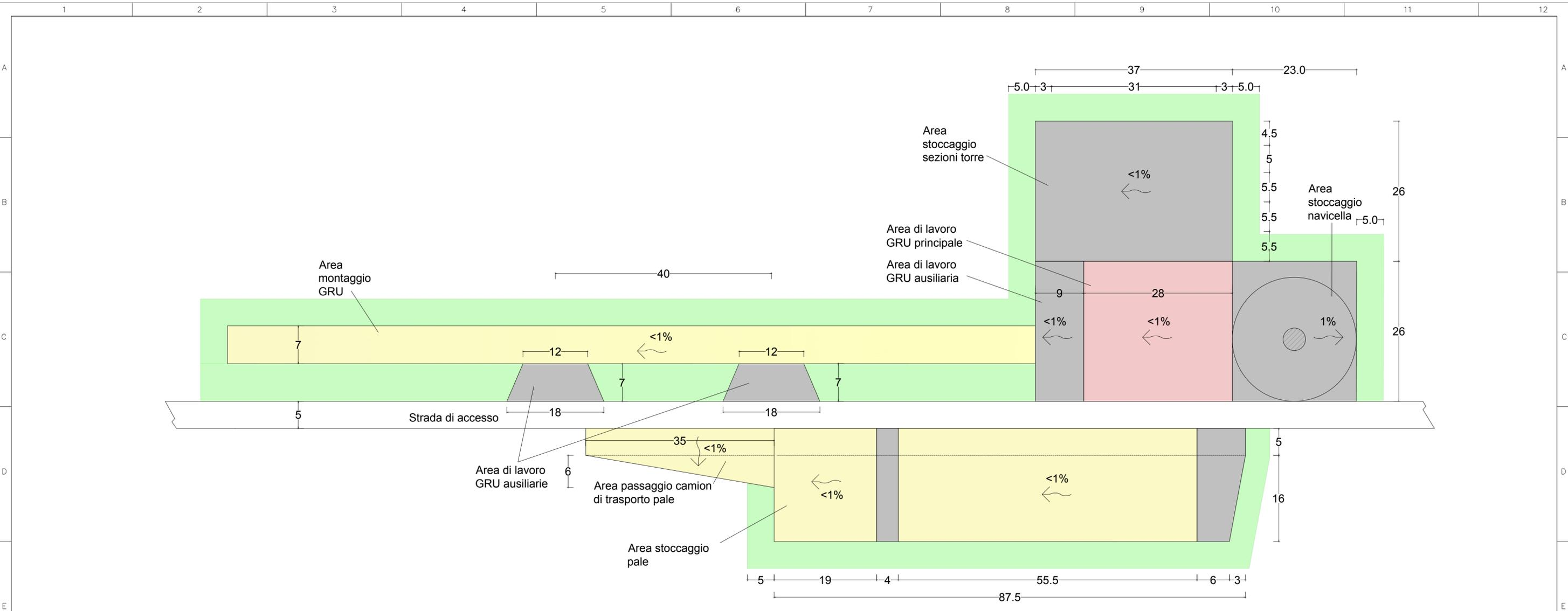
Stratigrafia aree in cui la capacità portante necessaria è pari a 5 kg/cm<sup>2</sup>
