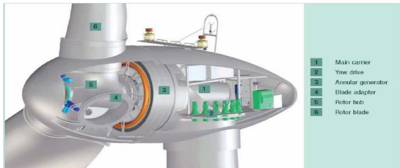
Fig. 59 - Elementi di una navicella - Fonte Enercon
