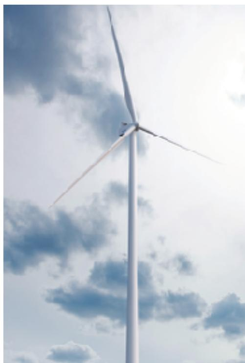
Trattasi di macchine ad asse del rotore orizzontale, in cui il sostegno (torre) porta alla sua sommità la navicella, costituita da un basamento e da un involucro esterno. All'interno di essa sono contenuti il generatore elettrico e tutti i principali componenti elettromeccanici di comando e controllo.
