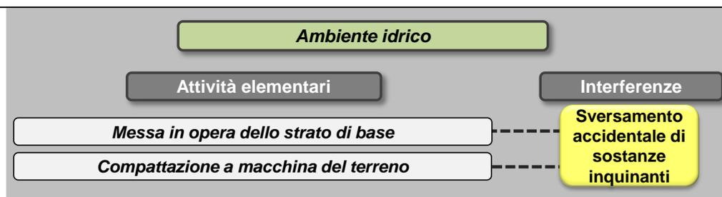
L'attività di costruzione di pavimentazioni in conglomerato bituminoso prevede l'impiego di mezzi meccanici che potrebbe comportare l'eventuale sversamento accidentale di sostanze nocive che, infiltrandosi nel terreno, potrebbero modificare la qualità delle acque sotterranee.
