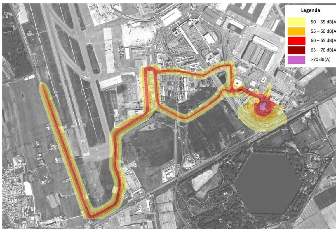
Figura 6-12 Curve di isolivello acustico indotte da sorgenti di cantiere e dal trasporto dei materiali, nel periodo diurno
