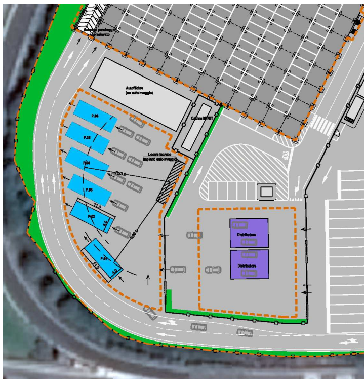
Figura 4 – Schema funzionale zona autolavaggio
