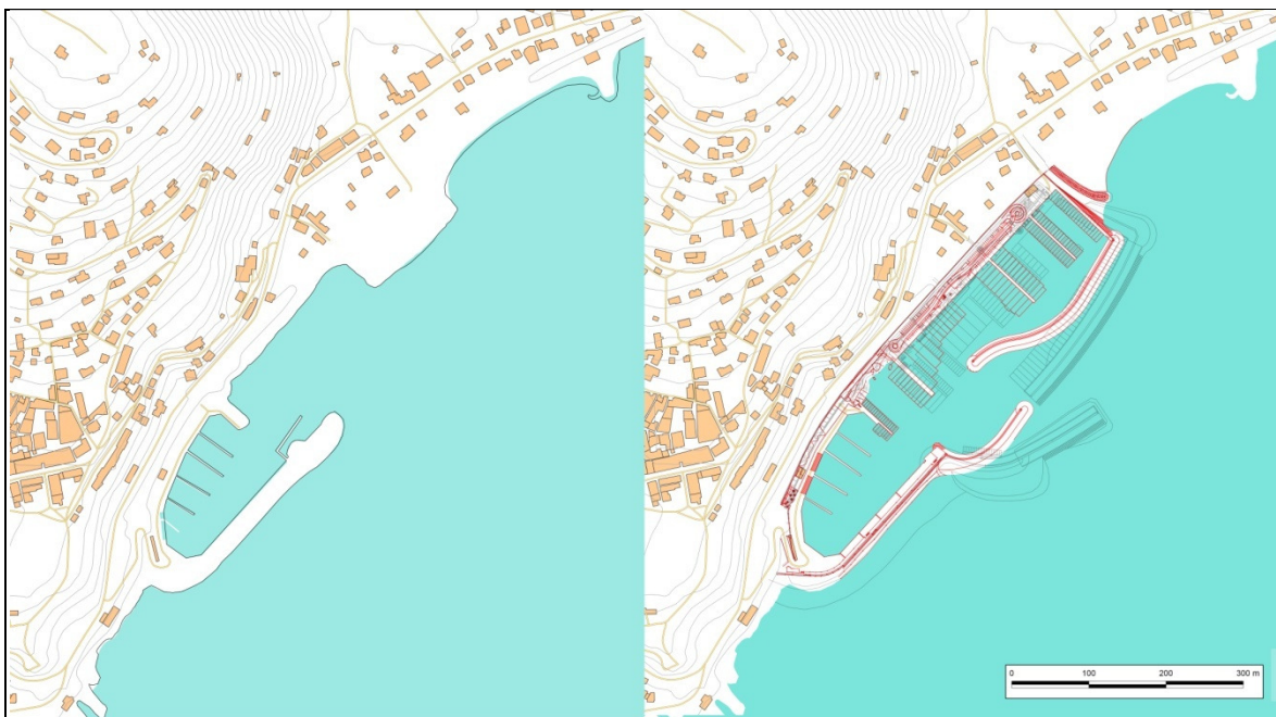
Figura 2-8 – Assetto costiero attuale (a destra) e di progetto (a sinistra in rosso, con sovrapposizione del precedente layout)
