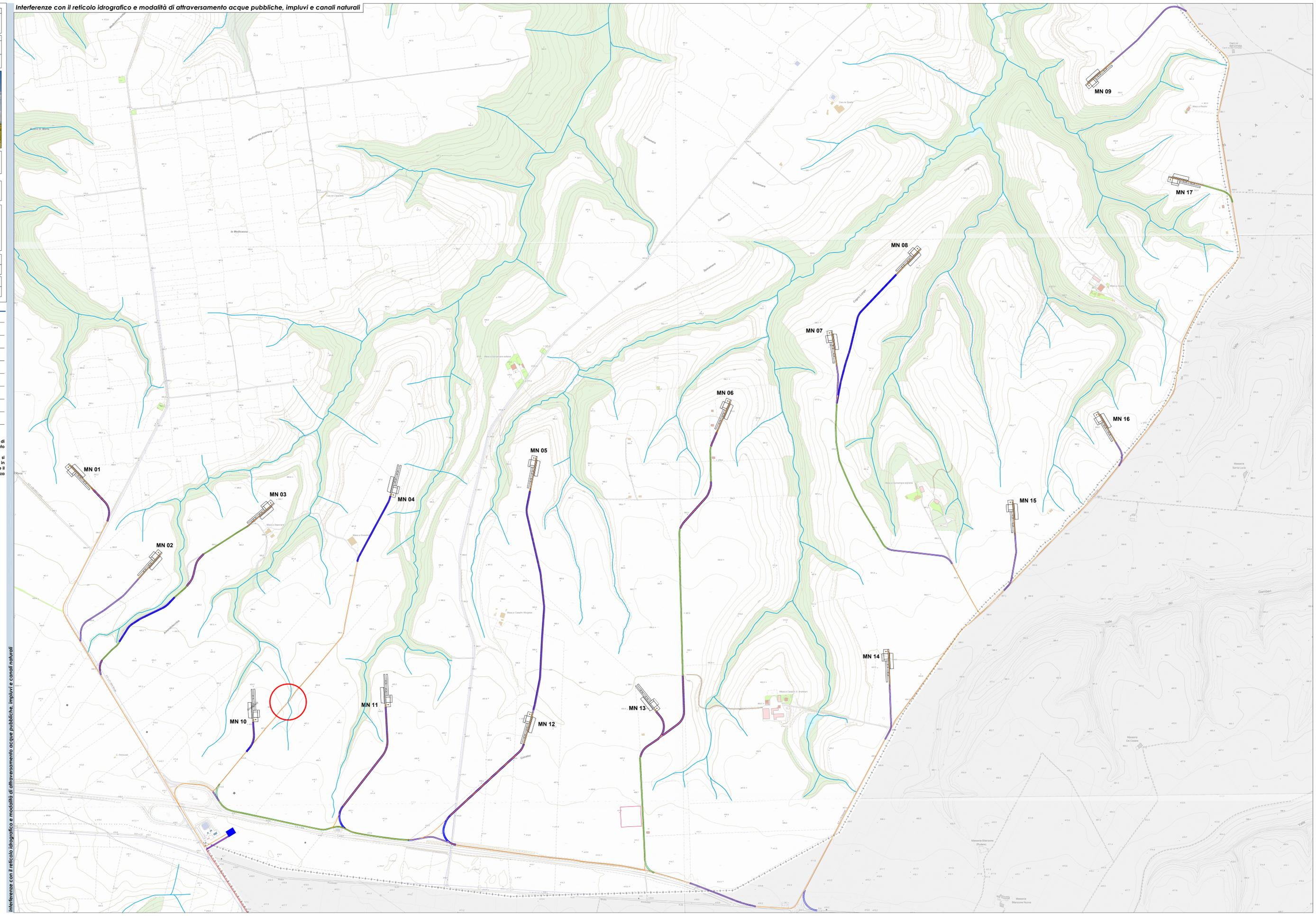
Interferenze con il reticolo idrografico e modalità di attraversamento acque pubbliche, impluvi e canali naturali
