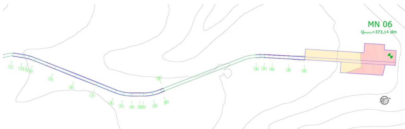
Figura 137 – Indicazione delle aree in scavo e riporto per la realizzazione del tronco MN06
