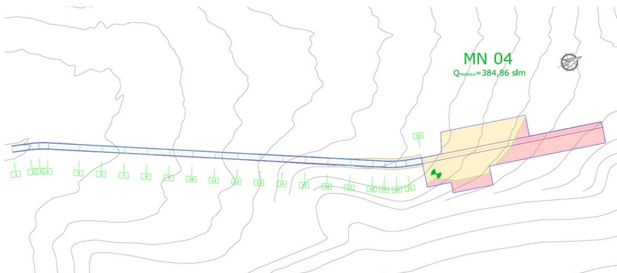
Figura 81 – Indicazione delle aree in scavo e riporto per la realizzazione del tronco MN4
