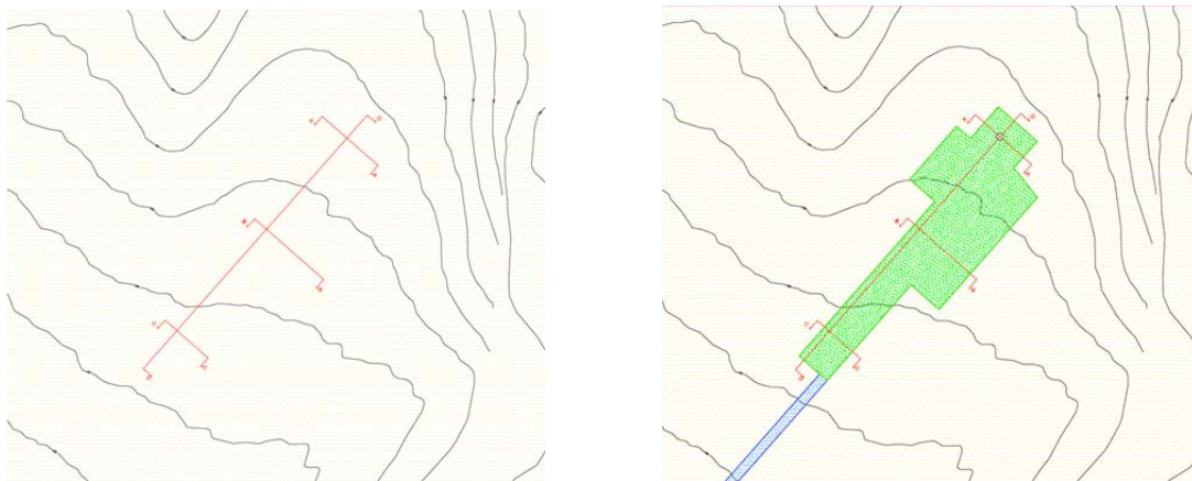
Figura 39 - Orografia del terreno in corrispondenza della piazzola di montaggio
