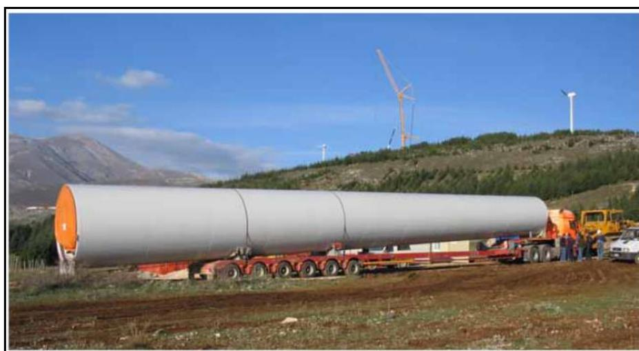
**Figura 16 - Foto del trasporto di un concio di turbina**
