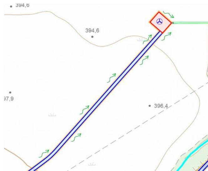
**Figura 9 - Esempio di deflusso delle acque meteoriche e sistema di convogliamento**
