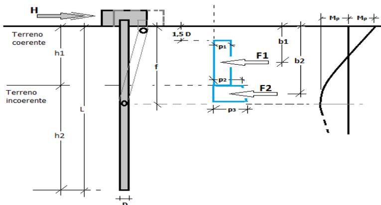
si determina la profondità  $f$  della seconda cerniera plastica.
