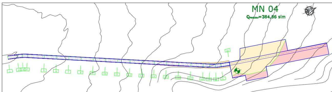
Figura 19 - Planimetria del ramo 4 e della piazzola relativa alla turbina MN04
