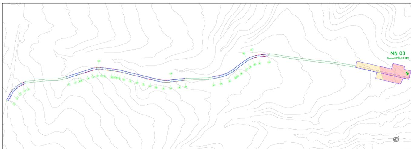
Figura 17 - Planimetria del ramo 3 e della piazzola relativa alla turbina MN03
