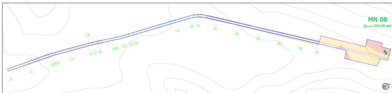
Figura 25 - Planimetria del ramo 8 e della piazzola relativa alla turbina MN08
