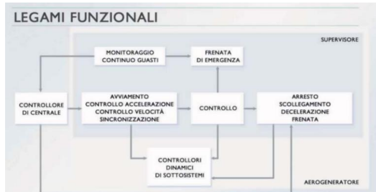
Figura 9: schema di controllo dell'aerogeneratore
