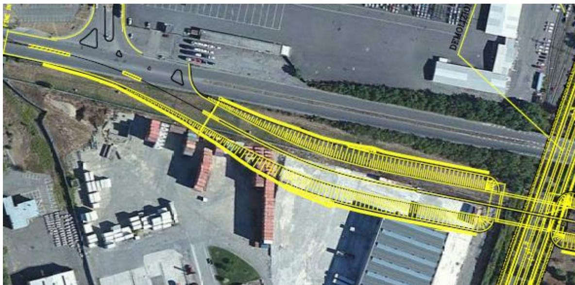
**Figura 6 – Sovrapposizione progetto definitivo rampa IR1M su ortofoto**
