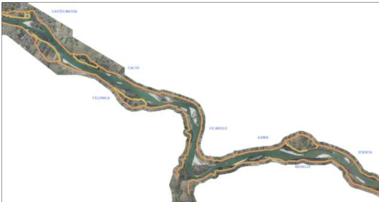
Tratto di Po interessato dalle opere di sistemazione con l'evidenziazione delle arginature maestre e golenali
