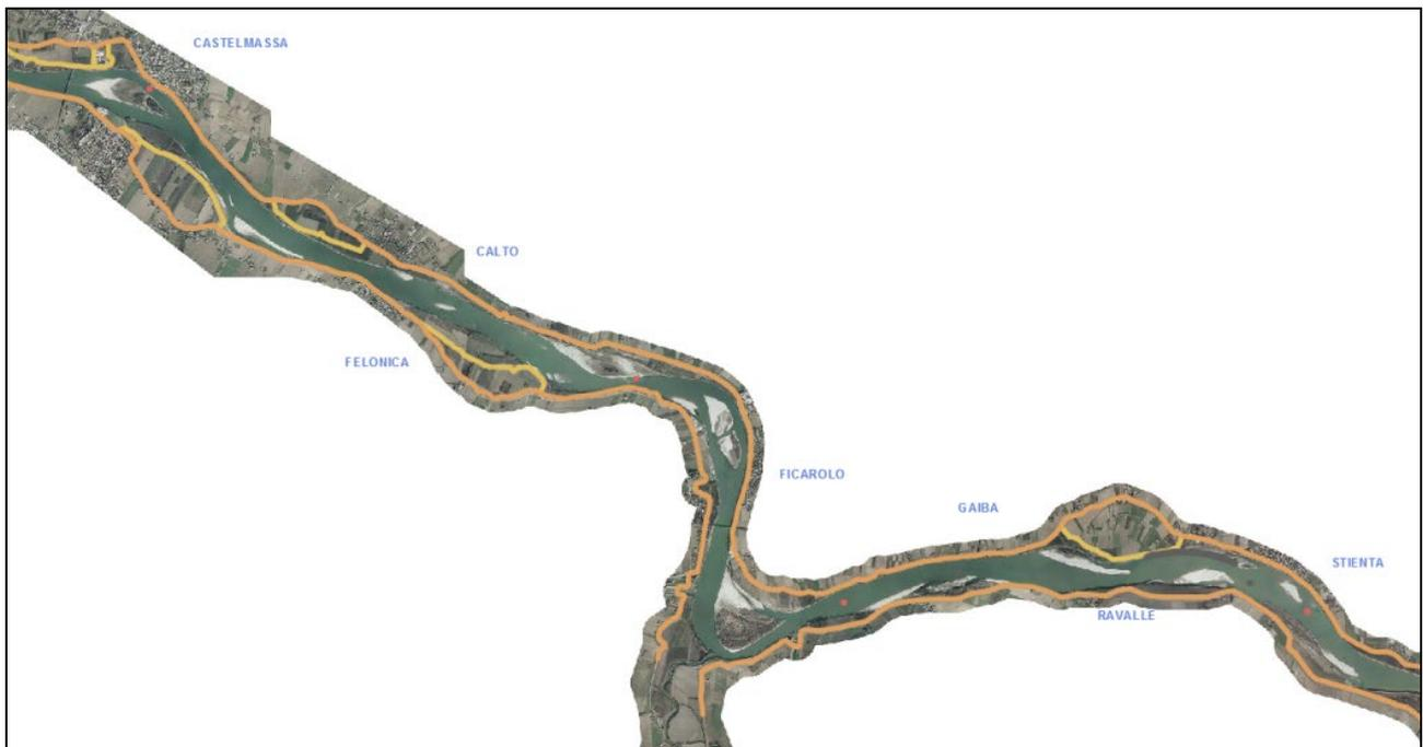
**Figura 3: tratto di Po interessato dalle opere di sistemazione con l'evidenziazione delle arginature maestre e golenali**
