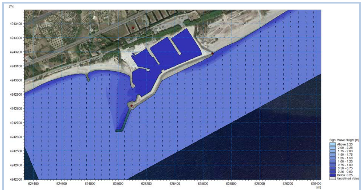
Fig. 10.7 Distribuzione dell'altezza d'onda per l'ipotesi di intervento 1 (2 cassoni REWEC3); condizione ondata in ingresso n.1 avente H_s=1,21m , direzione di provenienza 185^\circ N , T_p=5,88s
