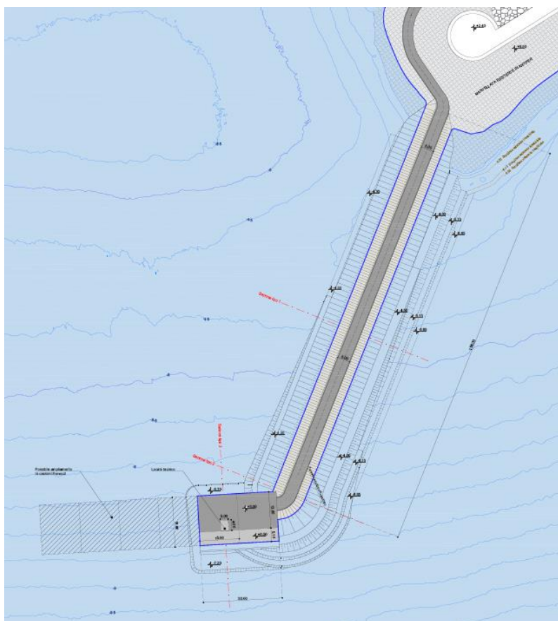
Figura 3.7 Intervento di ampliamento del molo sopraflutto
