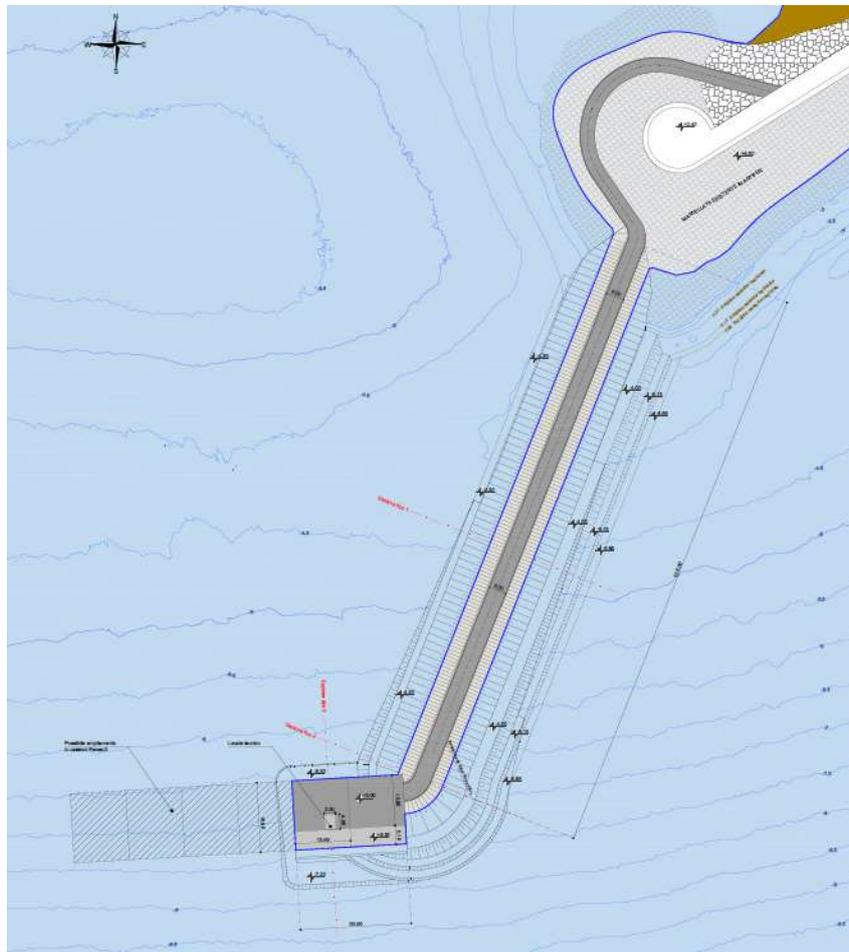
Figura 2.1 Intervento di ampliamento del molo sopraflutto
