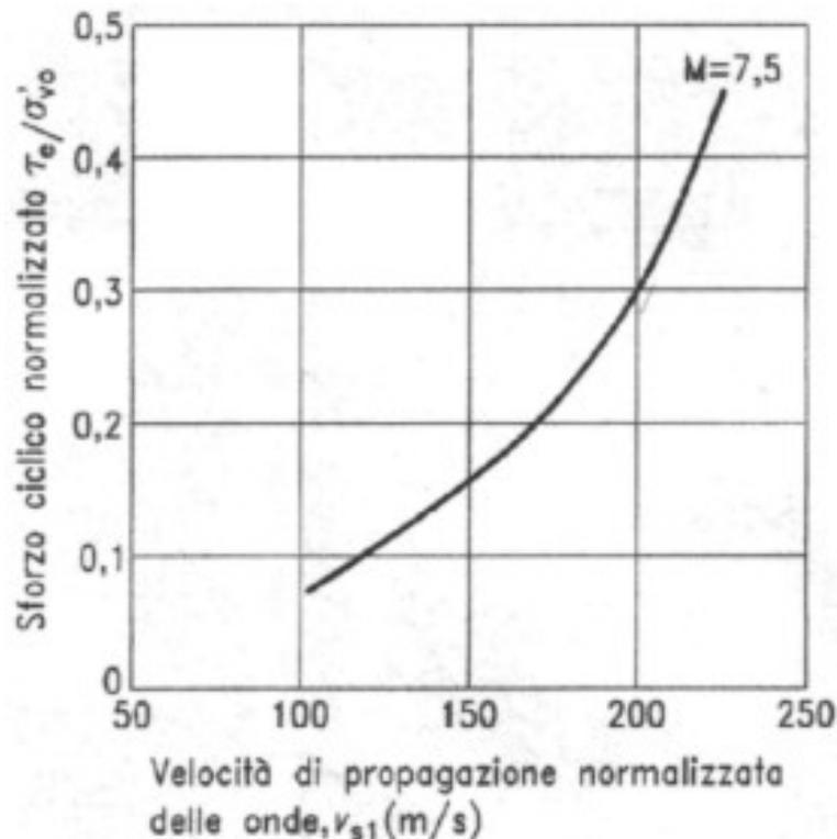
Figura 12.2 Metodo dell'Eurocodice 8 (SISMICA)
