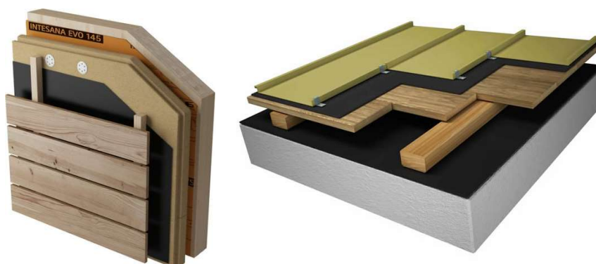
Figura 2.2 Sistema a cappotto (sx) e lamiera aggraffata copertura (dx)
