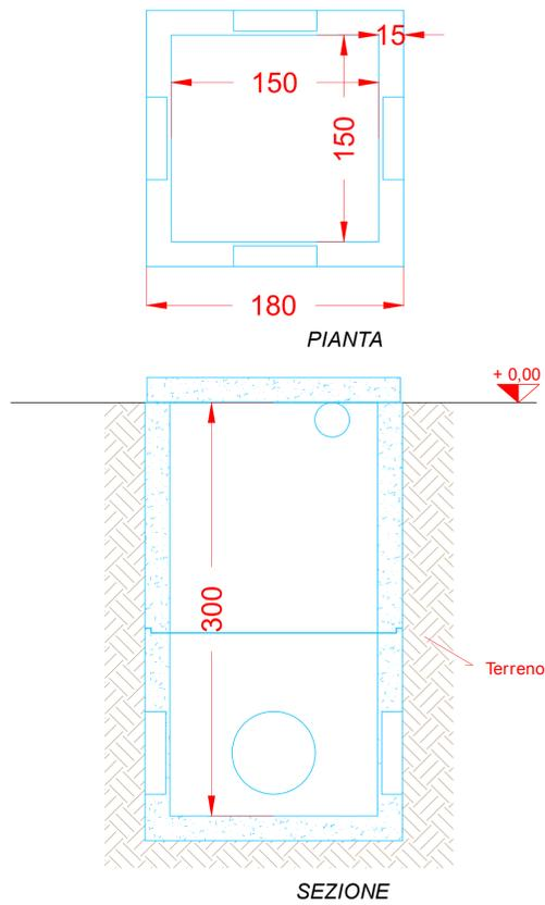
SERBATOIO IN VETRORESINA PER APPROVVIGIONAMENTO IDRICO
