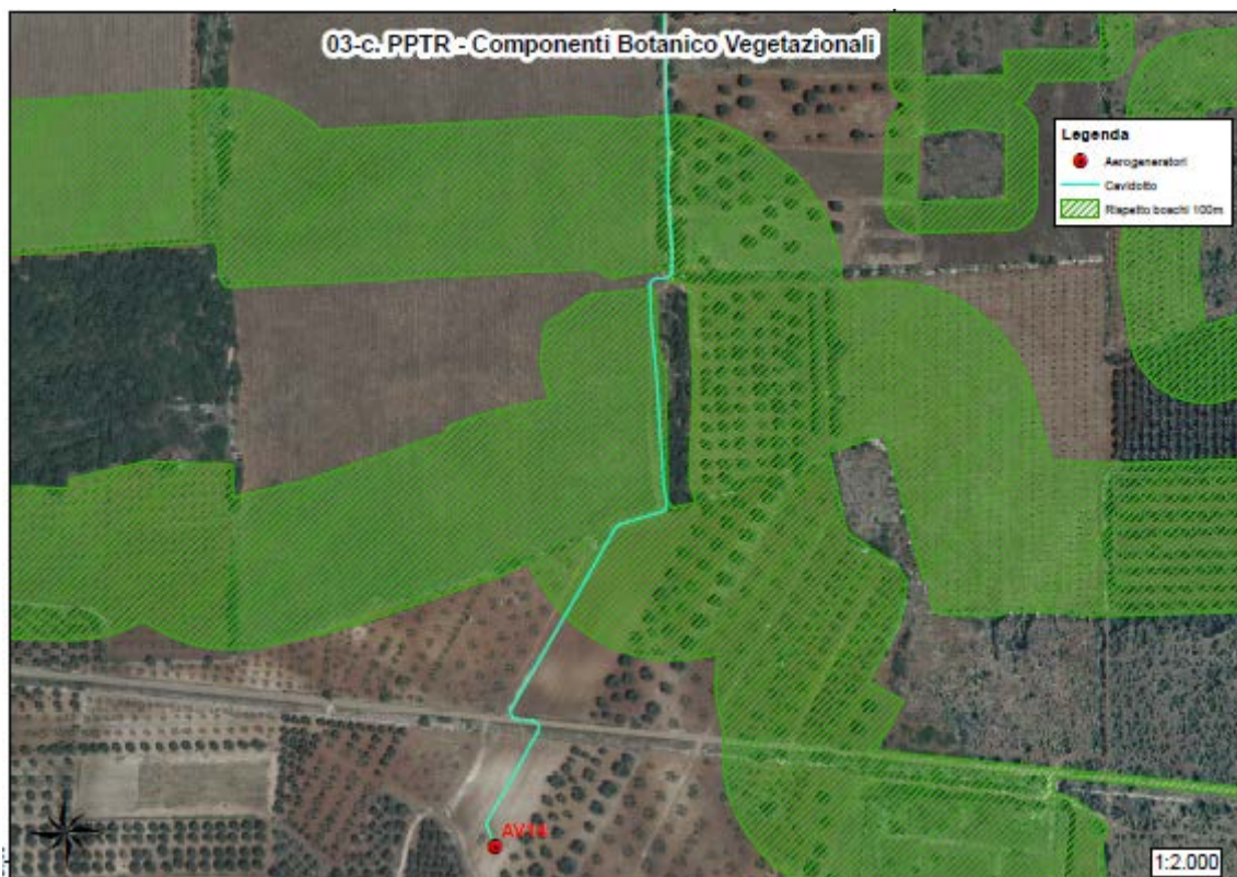
Il percorso del cavidotto interrato dalla AV14 interessa solo buffer di aree a macchia non producendo alcuna interferenza
