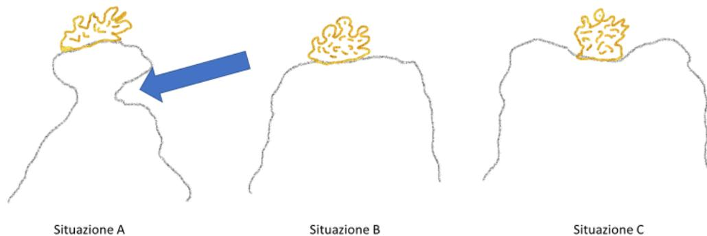
**Figura 5.1** Come descritto nel testo, il caso A è quello potenzialmente asportabile con i mezzi non impattanti (scalpello e mazzetta a mano) mentre i casi B e C non sono asportabili.
