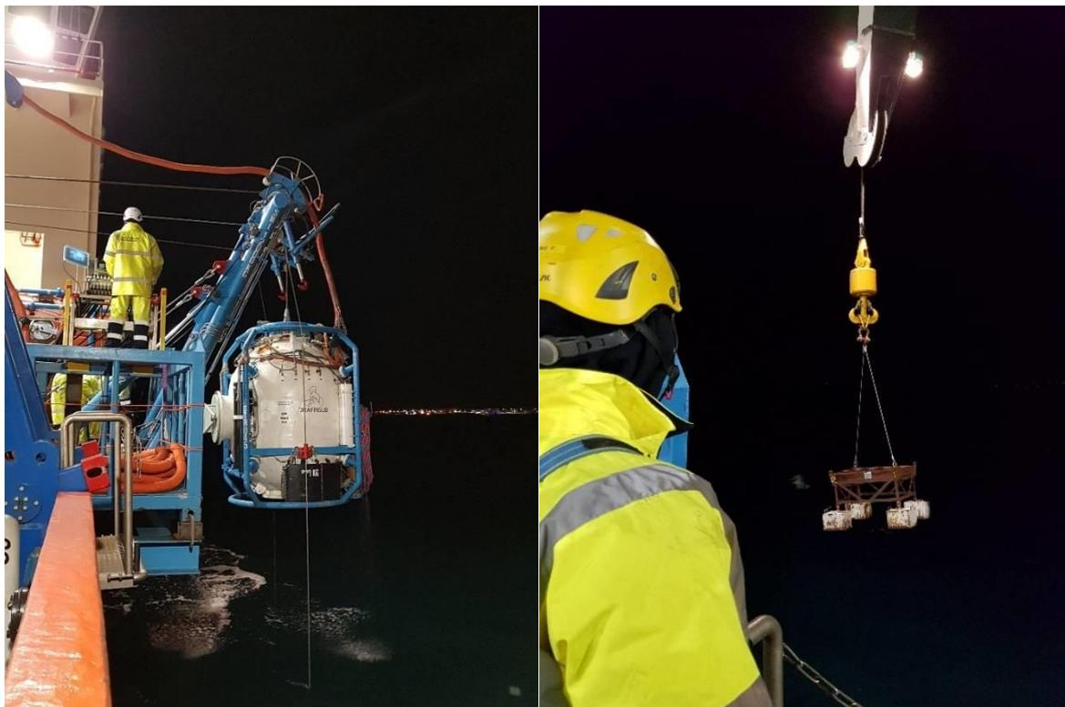
**Figura 6.18** *Calata in acqua della campana da immersione e il supporto di mantenimento*
