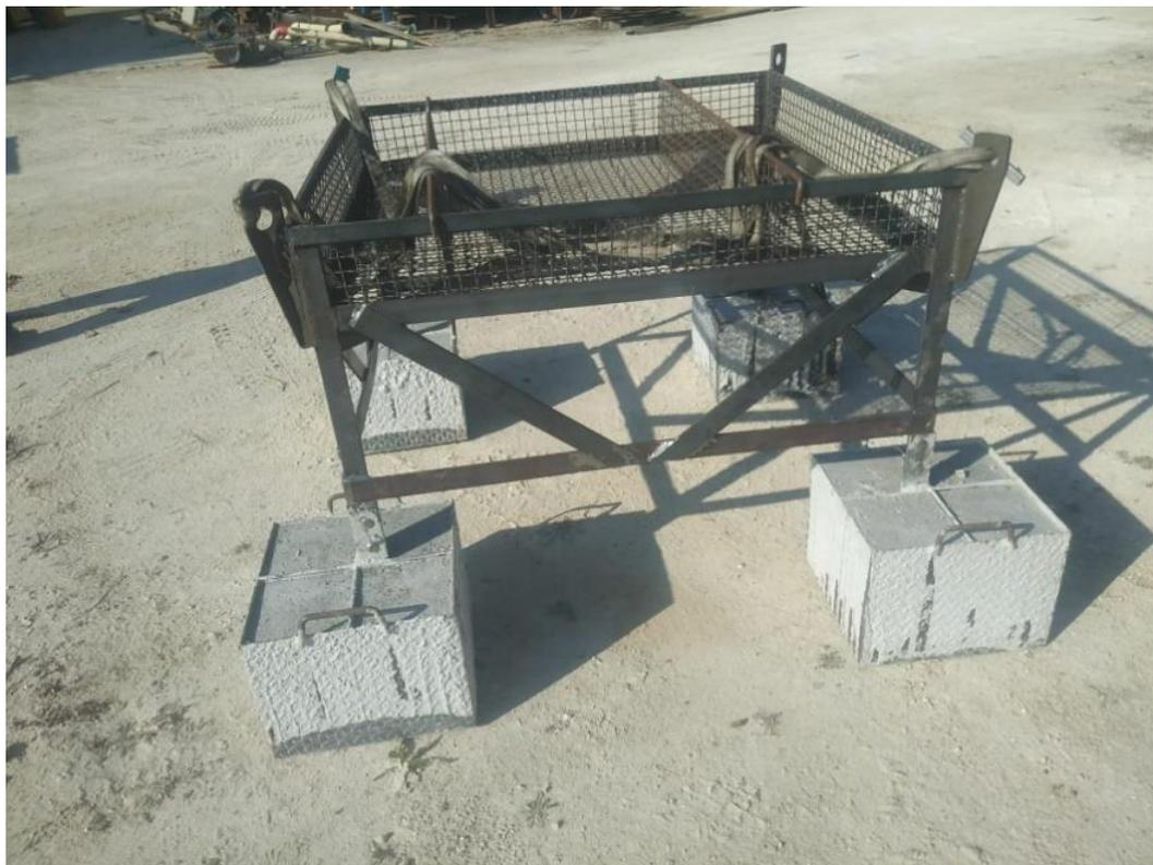
**Figura 6.15 Il supporto di mantenimento impiegato per mantenere in vita gli organismi prelevati fino al momento del trapianto. Il basamento e le sponde sono realizzati con un grigliato che favorisce la circolazione dell'acqua. Sono visibili i divisori interni per mantenere stabile il materiale conservato.**
