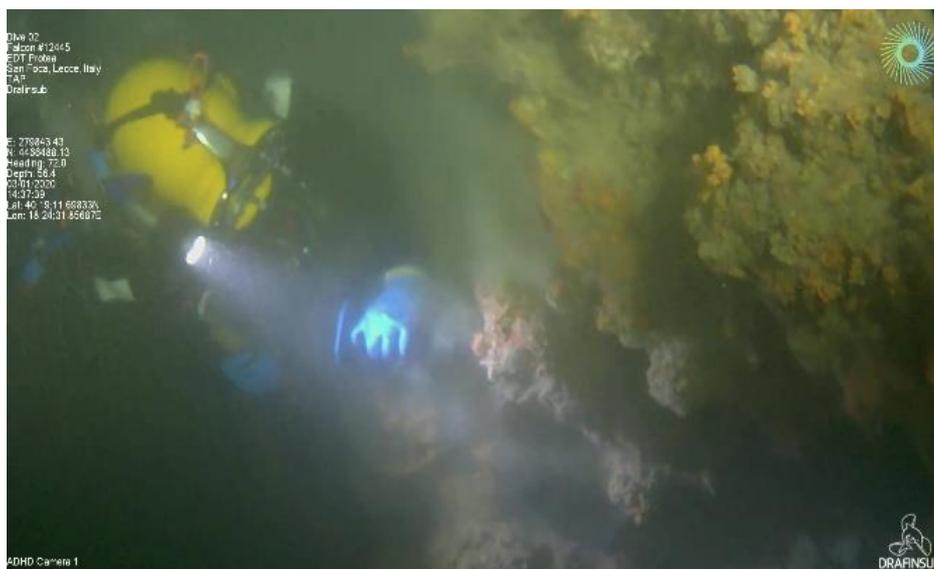
**Figura 6.21** *Mediante scalpello e martello il diver preleva selettivamente i nuclei di bioconcrezioni*
