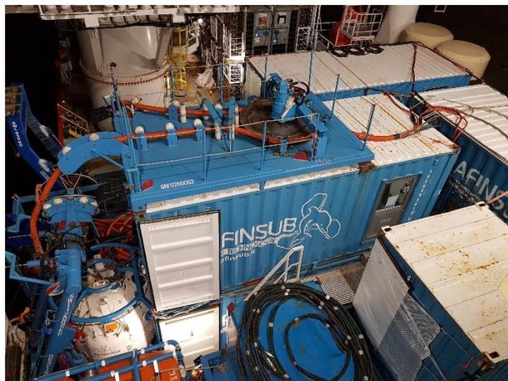
**Figura 6.9** L'impianto di saturazione "Raffaella" della DrafinSub a bordo della Protea
