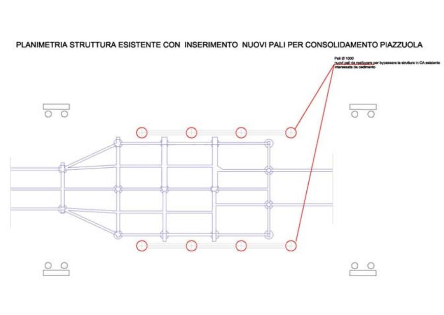
Figura 19. nuovi pali trivellati consolidamento piazzuola esistente
