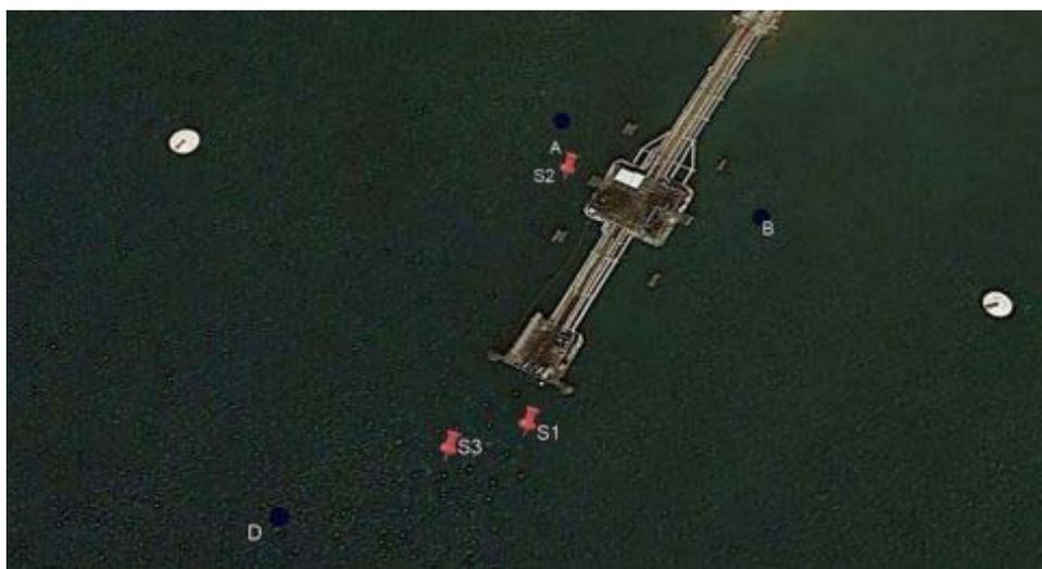
Figura 38: Ubicazione punti sondaggi S1, S2 e S3
