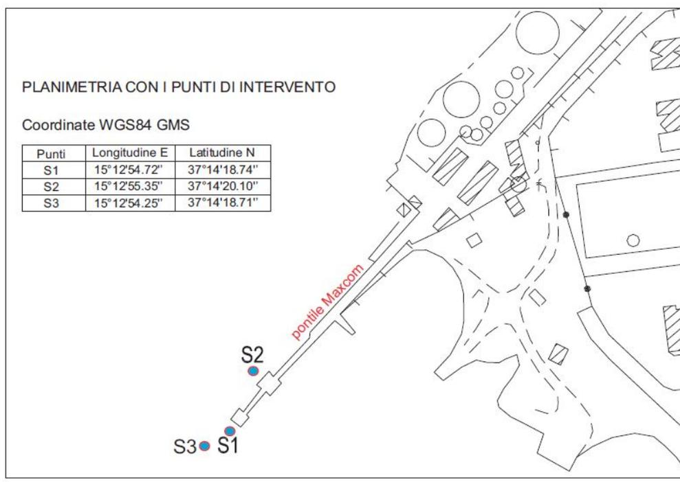
Figura 39: Ubicazione punti sondaggi S1, S2 e S3
