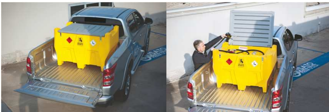
Figura 80 – Automezzo per il rifornimento mobile dei mezzi di cantiere - Fonte: Emiliana Serbatoi.
