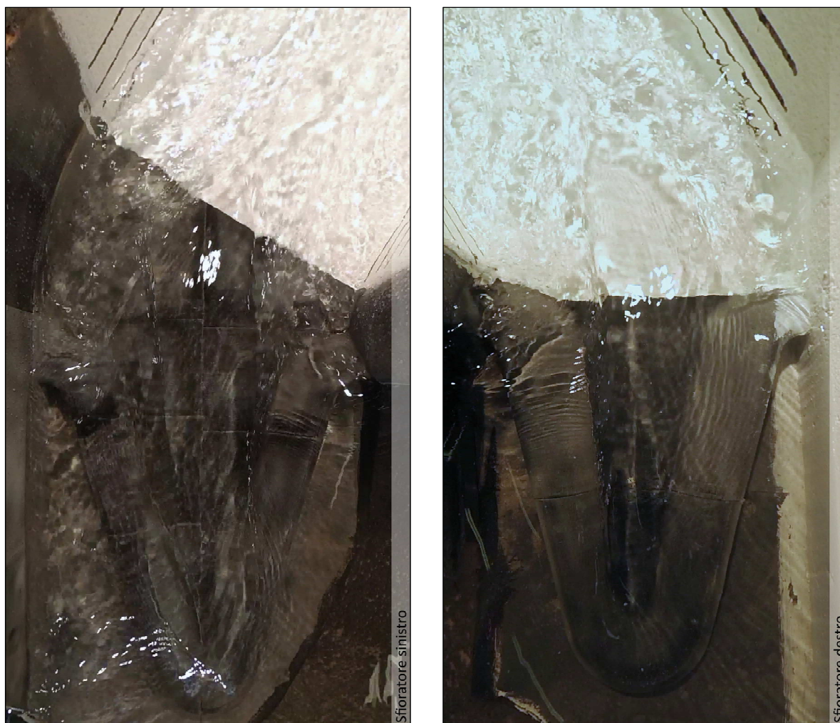
Foto 8 Sfioratore di destra interessato dalla portata su prototipo di 202 m 3 /s.
