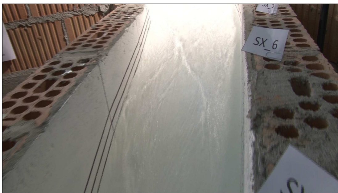
Foto 14 Livelli liquidi nella parte intermedia (in prossimità della sezione sx_6) del canale di fuga in sinistra per portata su prototipo Q = 202 \text{ m}^3/\text{s} .
