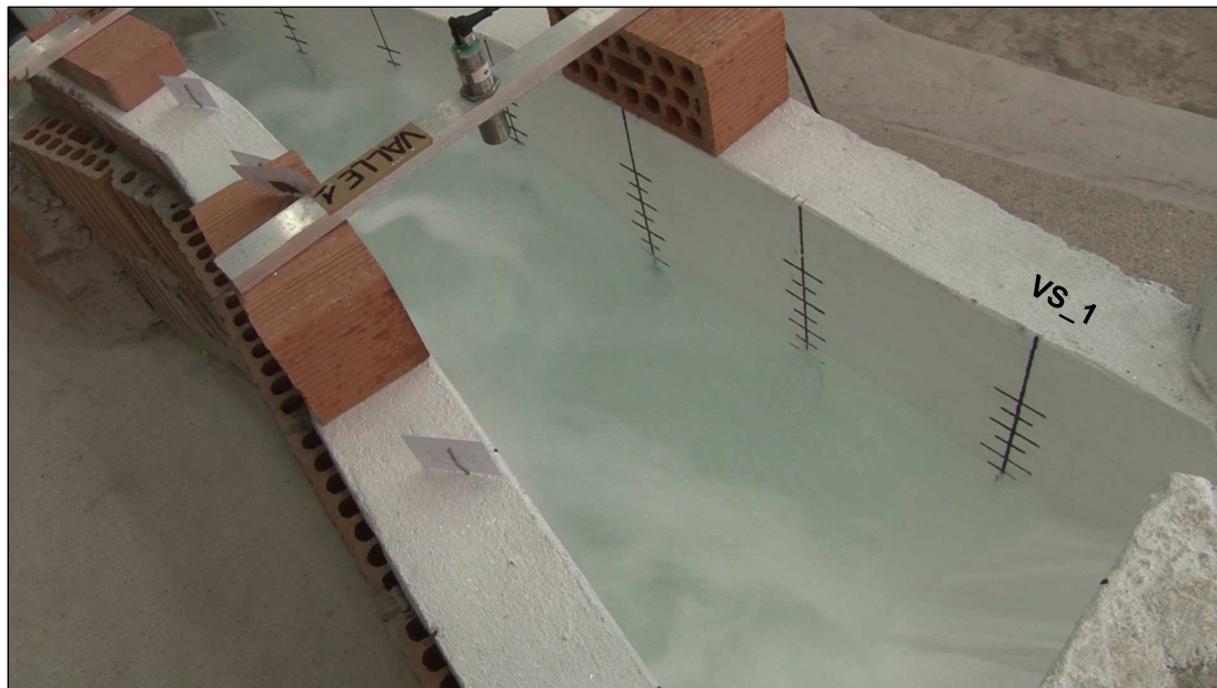
Foto 28 Variazione delle oscillazioni lungo la parete destra della vasca di dissipazione per la portata Q = 211 \text{ m}^3/\text{s} su prototipo (vista da monte delle sezioni da VS_1 a VS_6).
