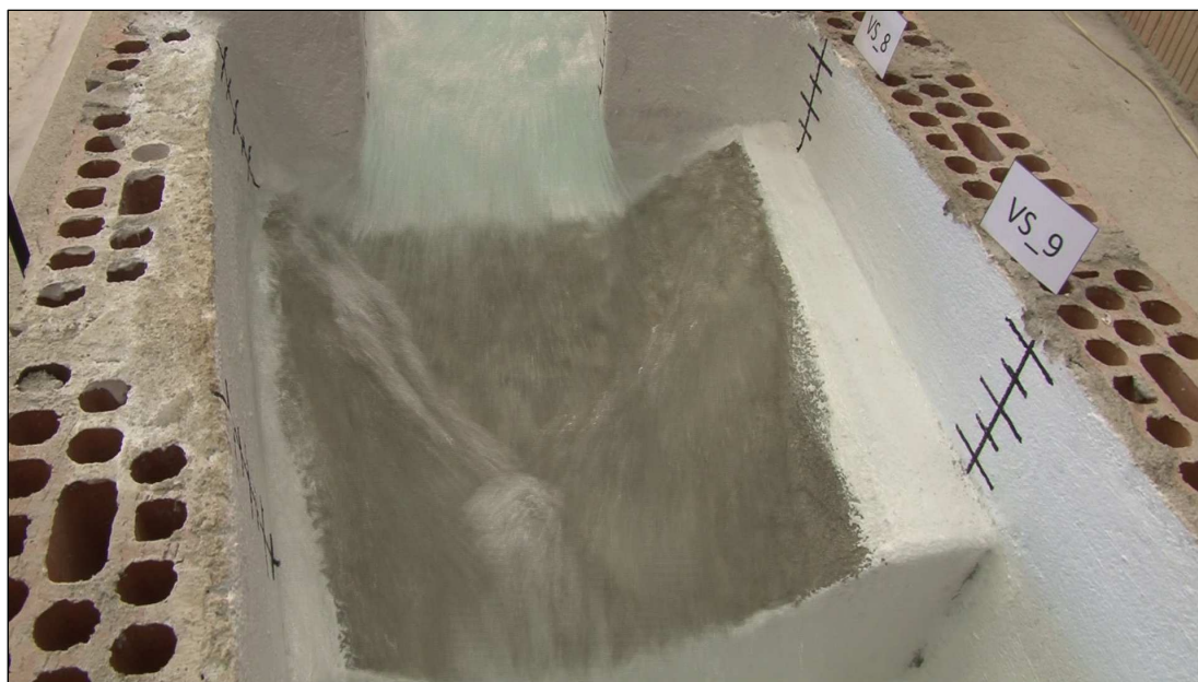
Foto 23 Restituzione della portata in alveo per Q = 211 \text{ m}^3/\text{s} su prototipo.
