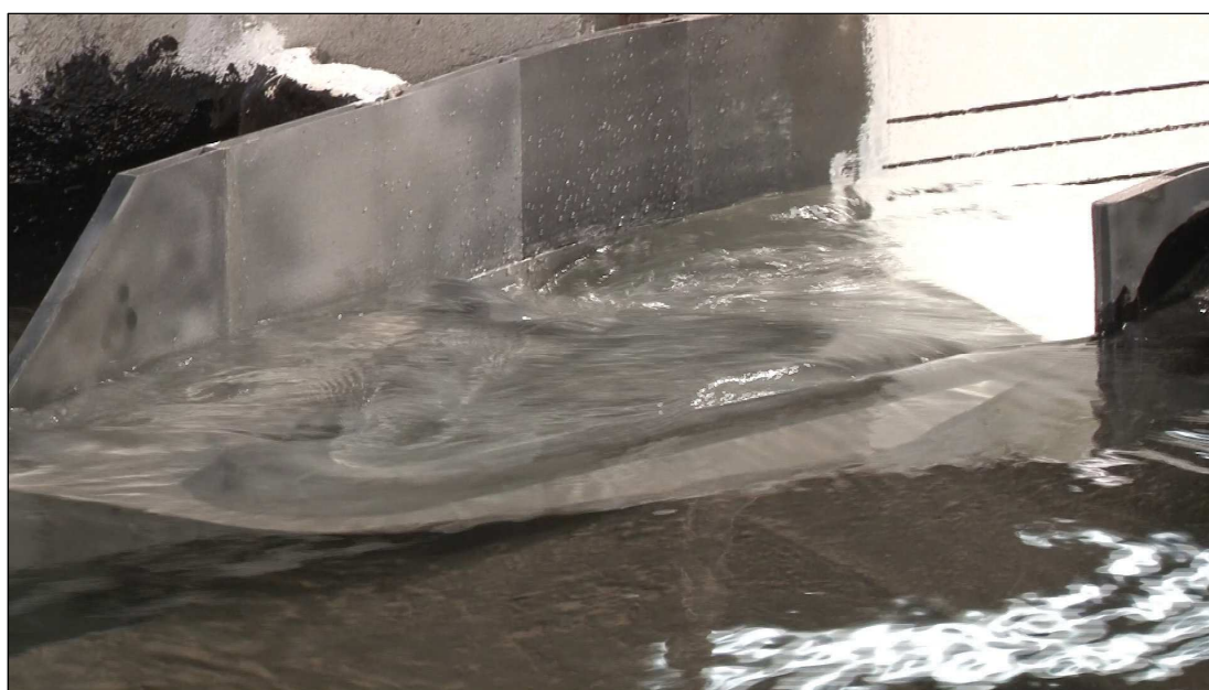
Foto 12 Vista da monte della parte sommitale del canale di fuga e del becco d'anatra in sinistra per portata su prototipo Q = 202 \text{ m}^3/\text{s} .
