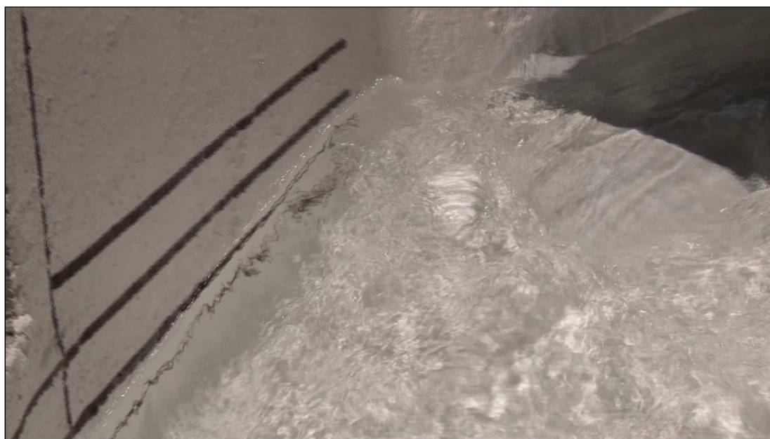
Foto 9 Livelli liquidi nella parte sommitale del canale di fuga in destra per portata su prototipo Q = 202 \text{ m}^3/\text{s} .
