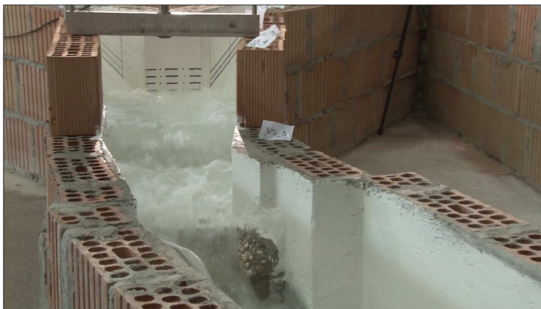
Foto 17 Vista complessiva del tratto terminale della vasca di dissipazione per portata su prototipo Q = 102 \text{ m}^3/\text{s} .
