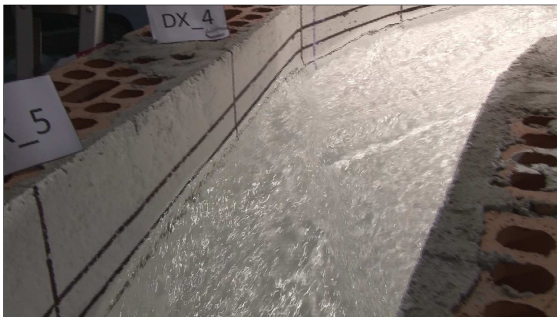
Foto 13 Livelli liquidi nella parte intermedia (in prossimità della sezione dx_4) del canale di fuga in destra per portata su prototipo Q = 202 \text{ m}^3/\text{s} .
