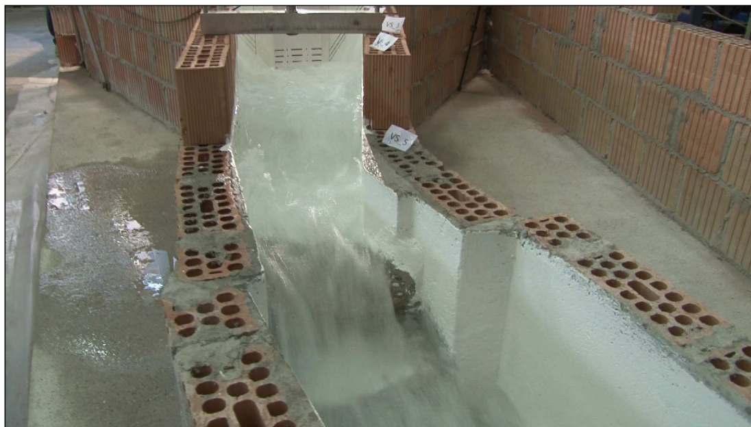
Foto 19 Vista complessiva del tratto terminale della vasca di dissipazione per portata su prototipo Q = 202 \text{ m}^3/\text{s} .
