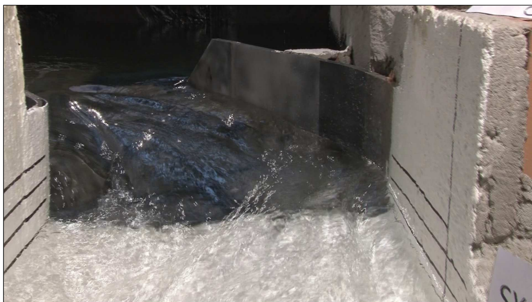
Foto 10 Livelli liquidi nella parte sommitale del canale di fuga in sinistra per portata su prototipo Q = 202 \text{ m}^3/\text{s} .
