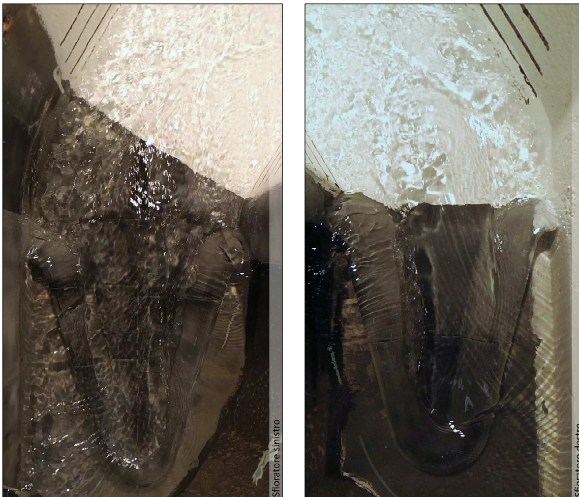
Foto 7 Comportamento dei due sfioratori per portata su prototipo di 144 \text{ m}^3/\text{s} .
