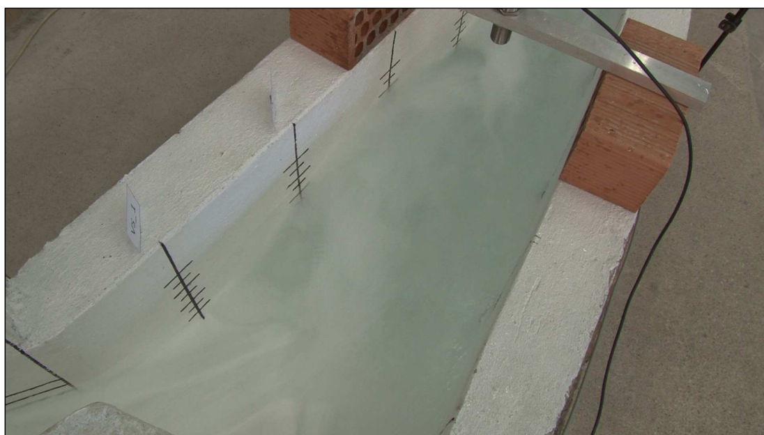
Foto 27 Ripresa del getto proveniente dal canale di fuga destro che impatta sulla sponda in sinistra fra le sezioni VS_2 e VS_3. Portata Q = 211 \text{ m}^3/\text{s} su prototipo.
