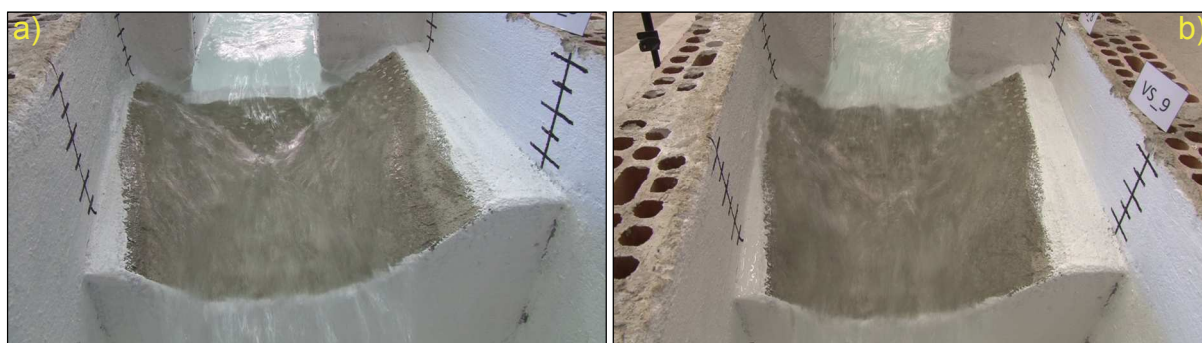
Foto 22 Restituzione della portata in alveo per: a) Q = 102 \text{ m}^3/\text{s} , e b) Q = 144 \text{ m}^3/\text{s} su prototipo.
