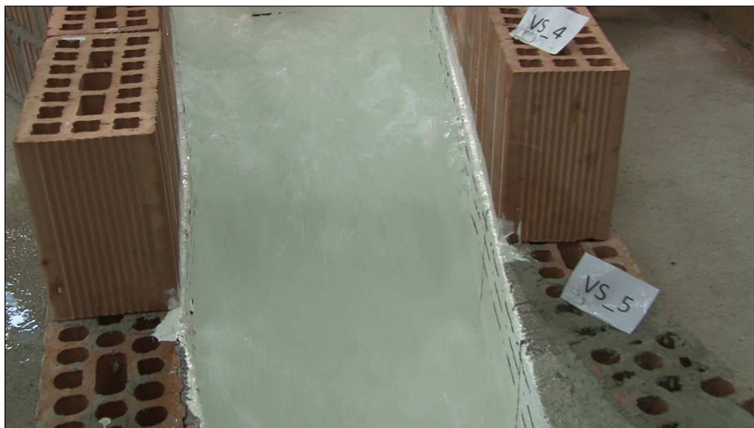
Foto 20 Livelli liquidi nel tratto terminale della vasca di dissipazione per portata su prototipo Q = 202 \text{ m}^3/\text{s} .
