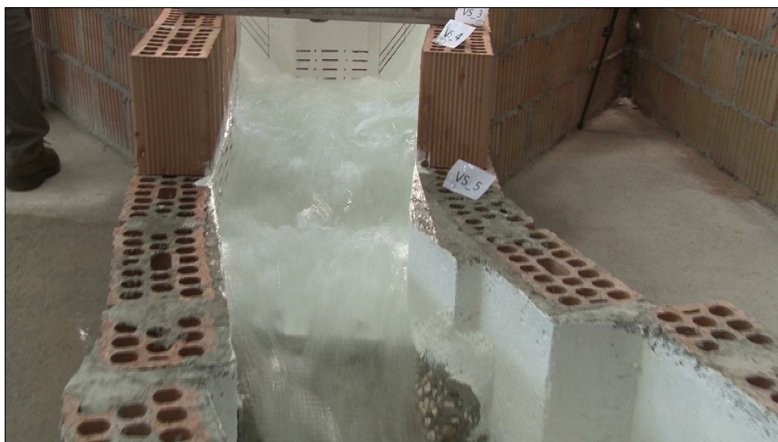
Foto 18 Vista complessiva del tratto terminale della vasca di dissipazione per portata su prototipo Q = 144 \text{ m}^3/\text{s} .
