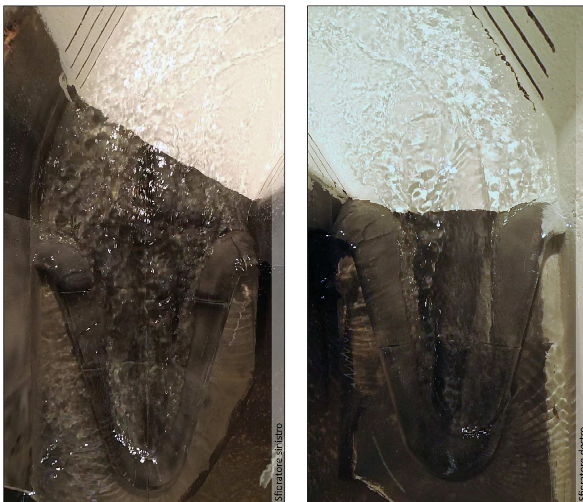
Foto 6 Comportamento dei due sfioratori per portata su prototipo di 102 m 3 /s.
