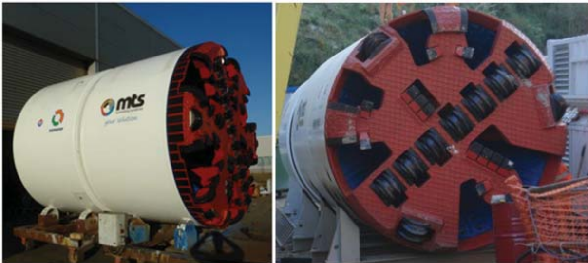
Figura 2.2 – A sinistra Microtunnel MTS Perforator, a destra testa mista adatta ad affrontare roccia e terreni argillosi.
