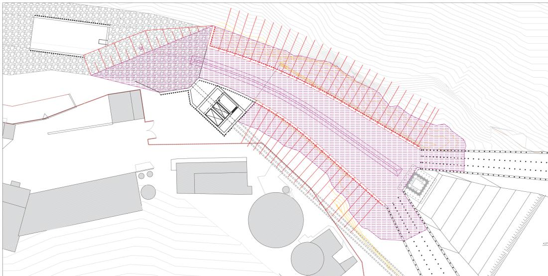
Fase 17 - Realizzazione rilevato per messa in opera micropali, realizzazione micropali e tiranti strada sinistra - 1:400
