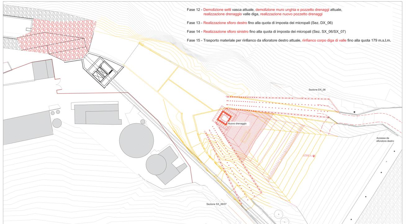
Fase 12 - Demolizione setti vasca attuale, demolizione muro unghia e pozzetto drenaggi attuale, realizzazione drenaggio valle diga, realizzazione nuovo pozzetto drenaggi
