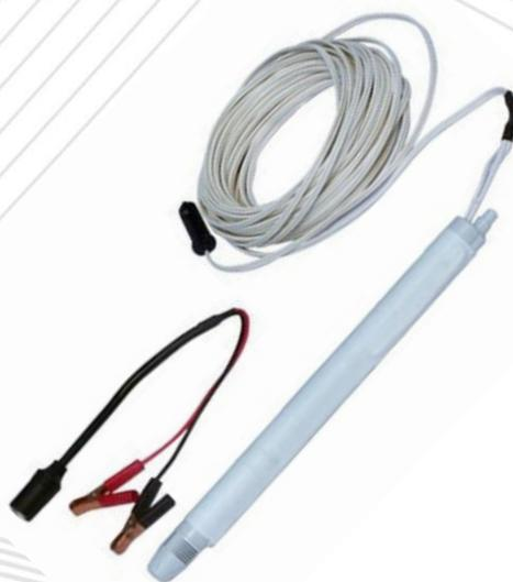
Le pompe Proactive Supernova 70 e Supernova 120 sono minipompe sommerse in PVC a 12 volt a diametro ridotto, 36 mm, con rotore ed alberino inox, che vengono impiegate sia per lo spurgo che per il campionamento di acque da piezometri di piccole dimensioni (< 2”). Possono parzialmente filtrare sabbia e detriti senza venire intasate o subire danneggiamenti.
