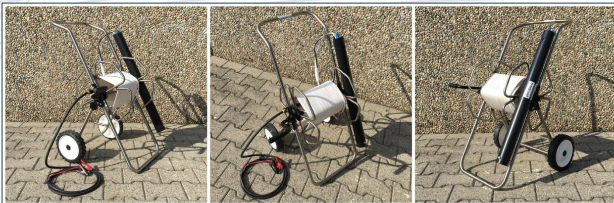
**RULLO AVVOLGICAVO PORTATILE SENZA TUBO:** allestito con porta-pompa, freno, collegamenti elettrici rapidi.
