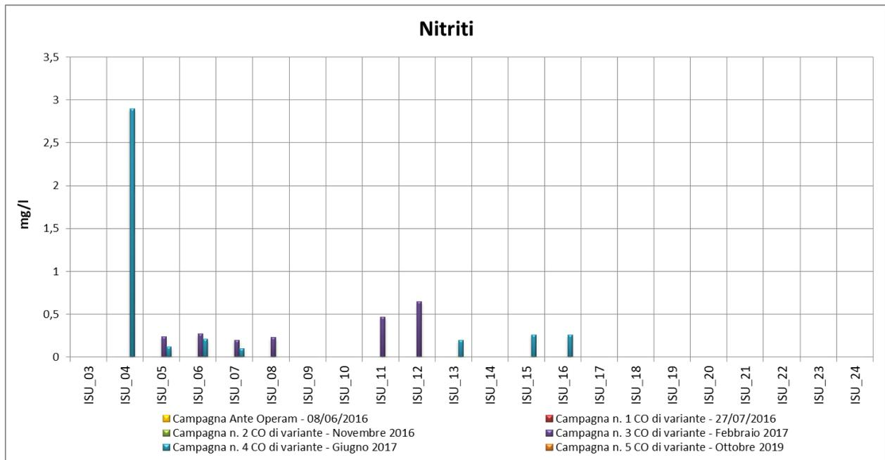
I nitriti (azoto nitroso) rappresentano uno stadio intermedio nel ciclo dell’azoto. Generalmente si originano dall’ossidazione dell’ammoniaca proveniente da processi di biodegradazione di sostanze organiche; più raramente possono derivare da processi di riduzione di nitrati. Poiché i nitriti sono trasformati facilmente e rapidamente in nitrati, la loro presenza, anche in tracce, è indizio di processo biologico in atto nell’acqua.
