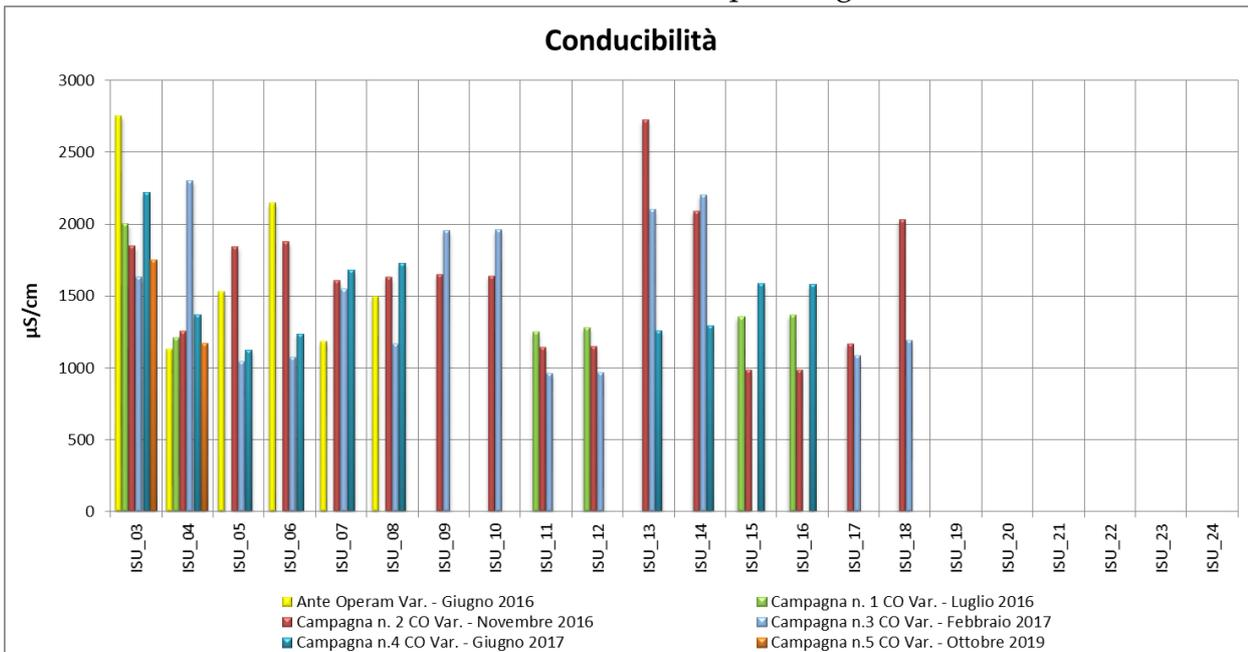
La conducibilità elettrica fornisce una misura della quantità di sali disciolti nell'acqua. Essa costituisce un buon indicatore del grado di mineralizzazione di un'acqua e viene espressa in µS/cm; maggiori sono le impurità contenute e maggiore è la conducibilità elettrica. Su tutte le sezioni monitorate in CO, i valori di conducibilità riscontrati risultano confrontabili tra le varie campagne e con i dati misurati in ante operam. Non si segnalano criticità da addurre al cantiere.
