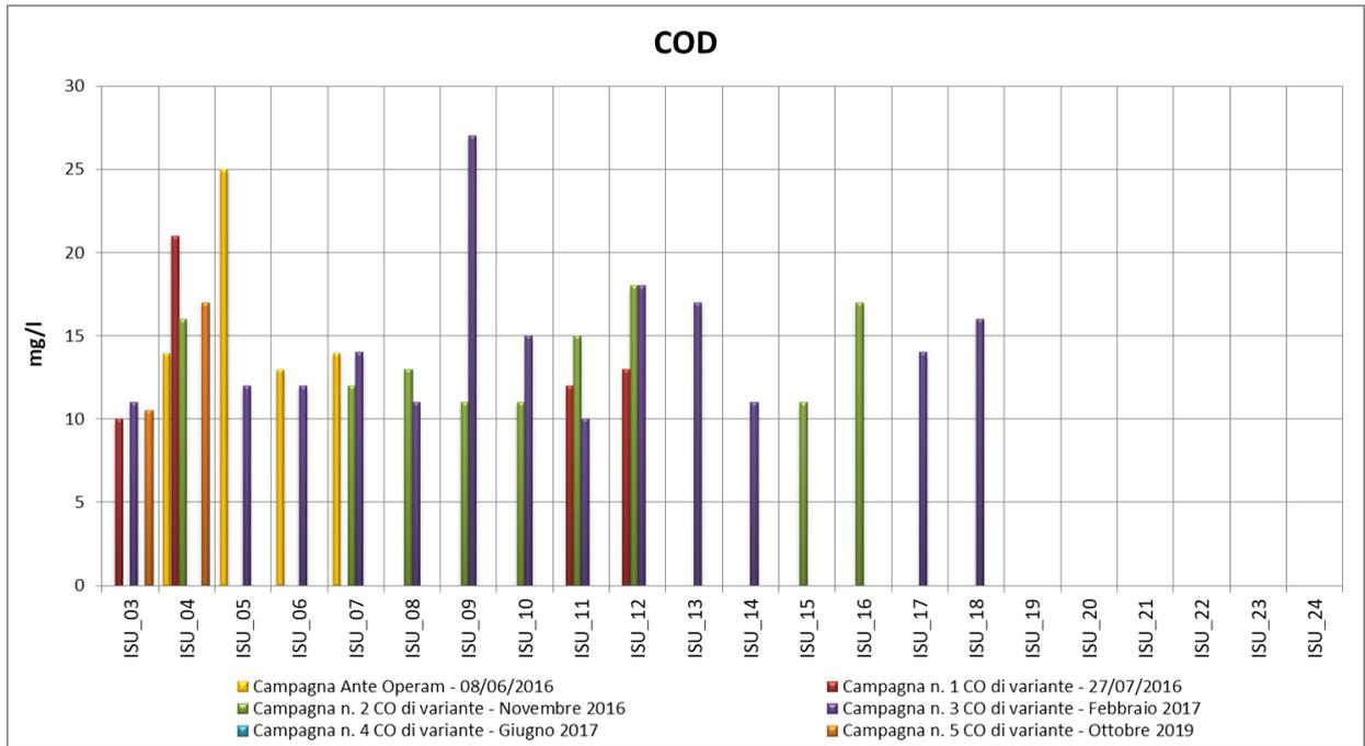
Insieme al BOD, il COD rappresenta uno dei parametri comunemente utilizzati per la misura indiretta del tenore di sostanze organiche presenti in un'acqua. L'andamento rilevato in CO ricalca quanto già esposto per il BOD5.
