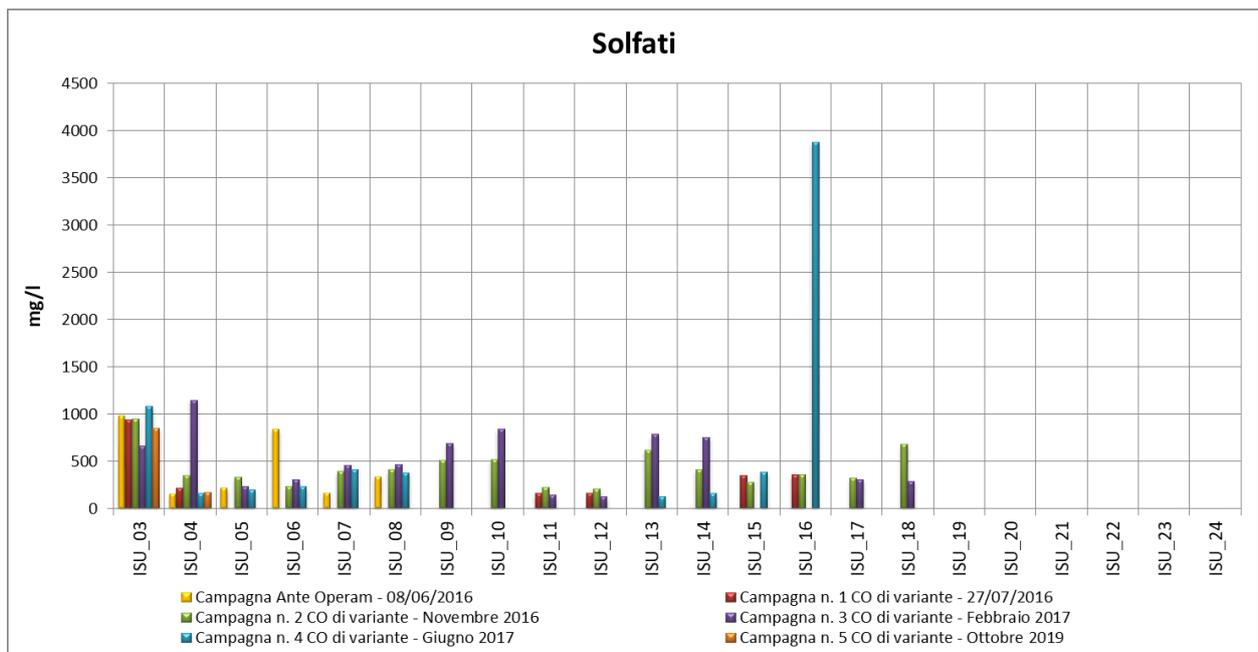
I solfati ( $SO_4^-$ ) sono composti contenenti zolfo e sono normalmente presenti nell'acqua in seguito al passaggio attraverso le rocce. Elevati livelli di solfati possono essere però riconducibili soprattutto ad inquinamenti dovuti all'agricoltura, dove vengono utilizzati come fertilizzanti, sebbene nell'area oggetto di monitoraggio insistono le formazioni geologiche evaporitiche della serie gessoso-solfifera messiniana, naturalmente ricche di solfati e facilmente solubili per dilavamento.
