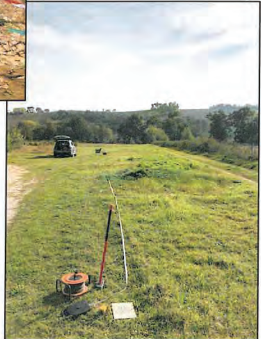
Foto 2 - Esecuzione della prova MASW1
