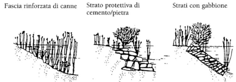
È essenziale un buon fessaggio al basamento per ottenere delle solide fondamenta per la parete, oppure utilizzare una struttura pesante, flessibile come i gabioni o i massi tondeggianti a gradini che si adattano a seconda dei cambiamenti di forma dovuti all'erosione del basamento.
