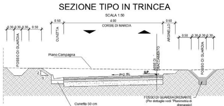
Figura 4 – Sezione tipo in trincea
