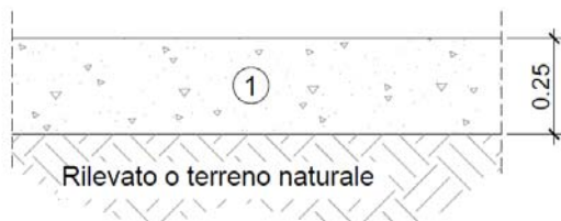
Figura 3 Dettaglio pavimentazione viabilità Poderale
