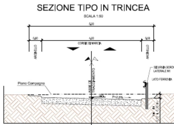
Figura 4 Sezione tipo in trincea
