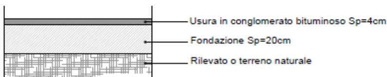
Figura 5 Dettaglio pavimentazione
