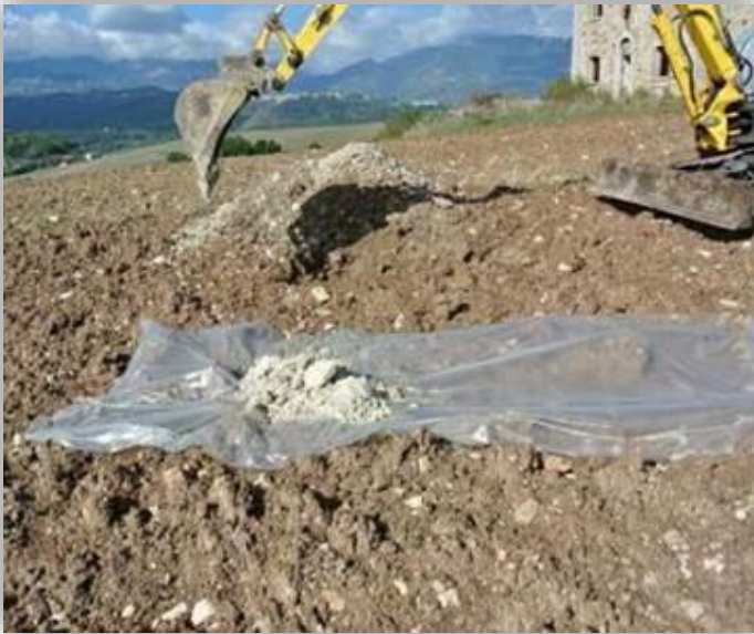
Figura 10-1: Scavo realizzato con pala meccanica. Consente di osservare la sequenza litologica sulle pareti dello scavo stesso e di verificare la presenza di una falda superficiale.
