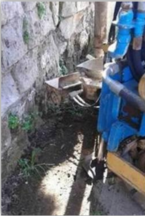
Figura 10-3: Sondaggio effettuato mediante perforazione a carotaggio.
