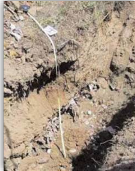
Figura 10-1: Scavo realizzato con pala meccanica. Consente di osservare la sequenza litologica sulle pareti dello scavo stesso e di verificare la presenza di una falda superficiale.
