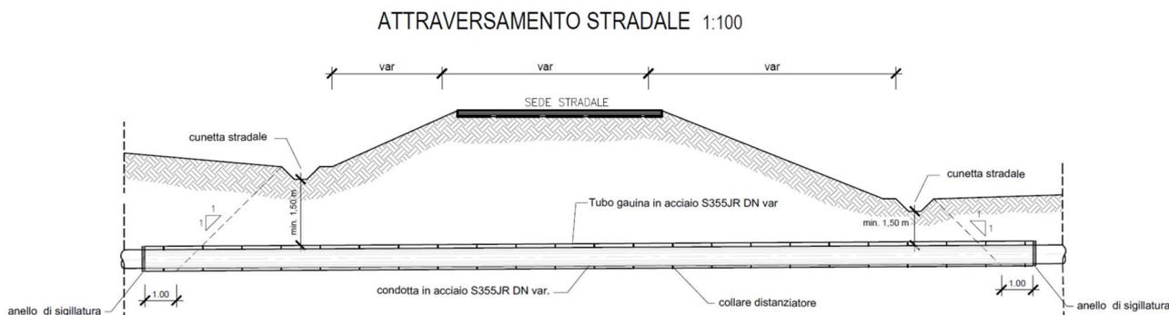
Figura 18 -Attraversamenti stradali con spingitubo – fuori scala – (Tav B9)
