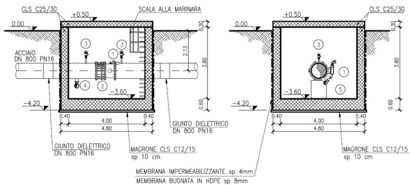
Figura 12 – Schema architettonico tipico dei Nodi di sezionamento – fuori scala (Tav. da B5 e B5.1)
