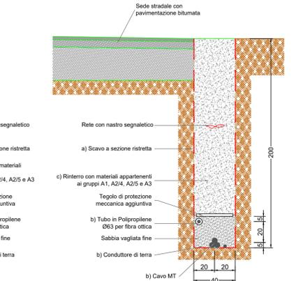
**TIPOLOGIA 2.1: Elettrodotto in banchina di strada esistente in conglomerato bituminoso**
