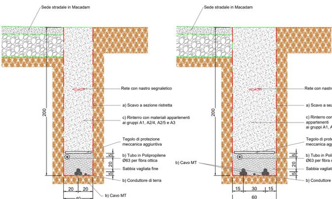
**TIPOLOGIA 1.2: Elettrodotto in banchina di strada esistente con pavimentazione naturale**
