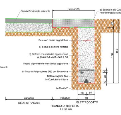
**TIPOLOGIA 5.2: Elettrodotto in banchina di Strada Provinciale in conglomerato bituminoso**
