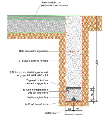
**TIPOLOGIA 2.2: Elettrodotto in banchina di strada esistente in conglomerato bituminoso**
