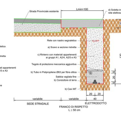
**TIPOLOGIA 5.1: Elettrodotto in banchina di Strada Provinciale in conglomerato bituminoso**
