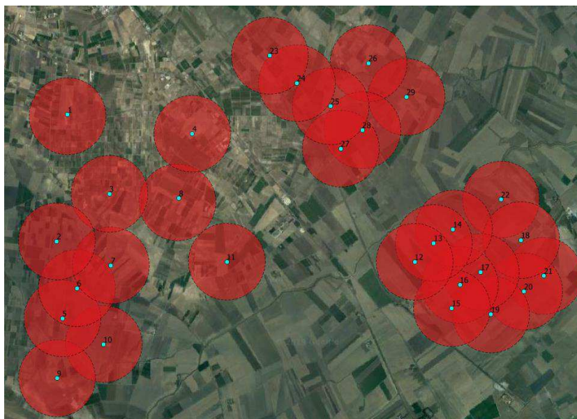
Individuazione Buffer da asse aerogeneratori (5 volte il diametro del rotore)
